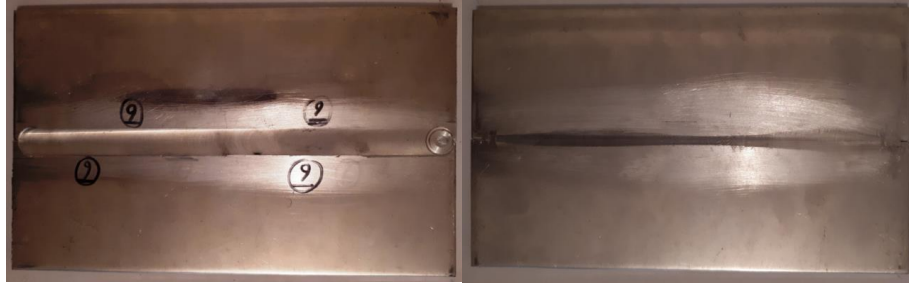
Şekil 5.1 Farklı parametreler ile kaynak edilmiş levhalar - 3
