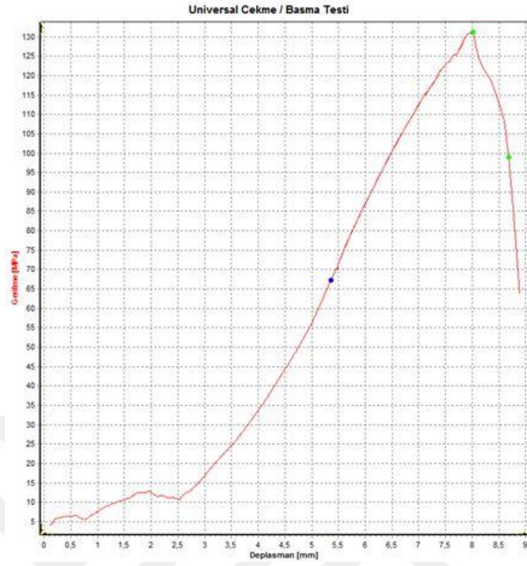
Şekil A.26 Çekme eğrisi 92 nolu numune
