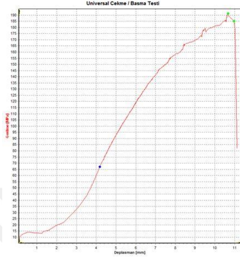
Şekil A.20 Çekme eğrisi 72 nolu numune
