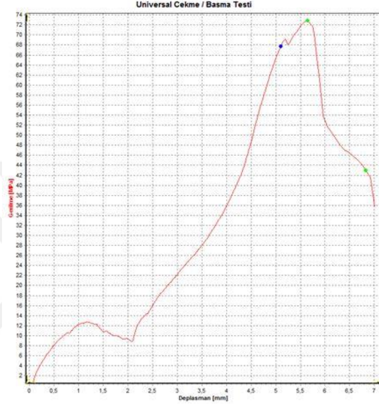
Şekil A.1 Çekme eğrisi 11 nolu numune
