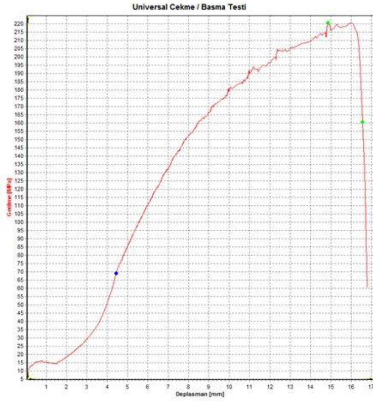
Şekil A.11 Çekme eğrisi 42 nolu numune
