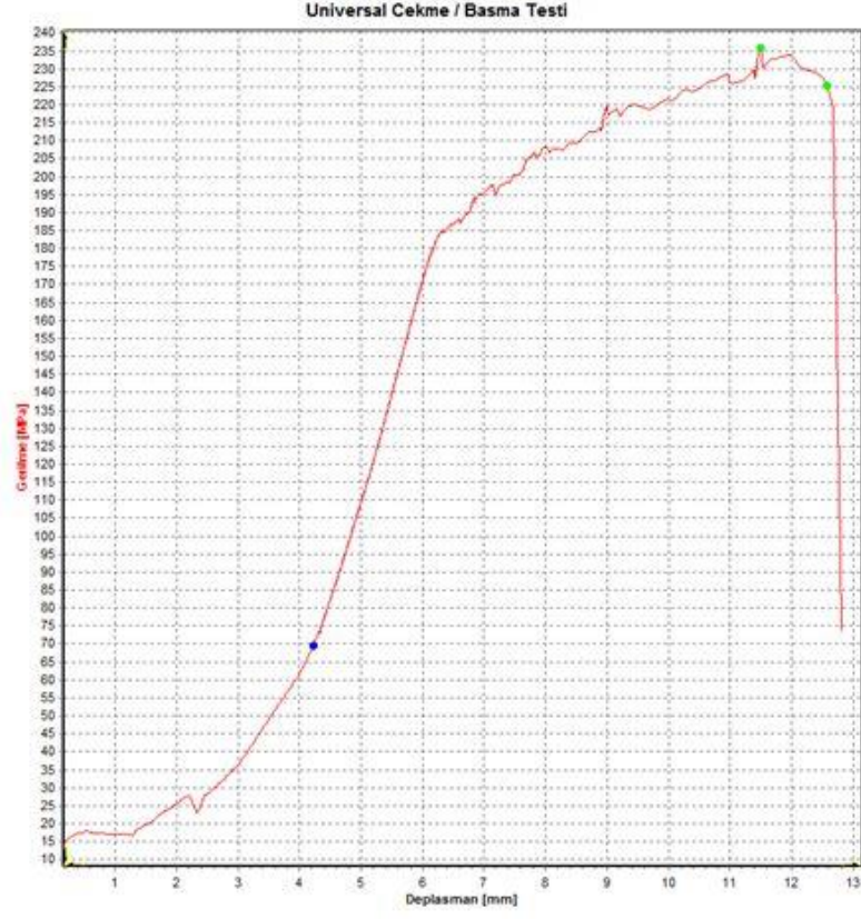
Şekil A.18 Çekme eğrisi 63 nolu numune
