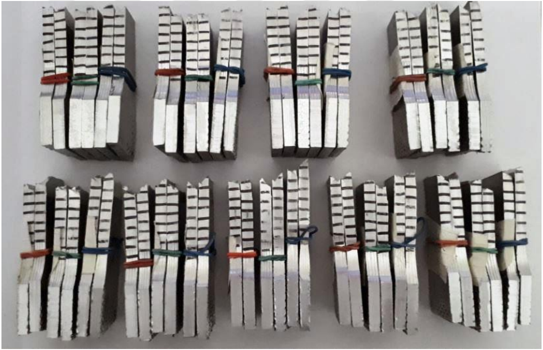
Şekil 5.2 Çekme testi numunelerinin test sonrası yüzey ve kesit görünüşleri
