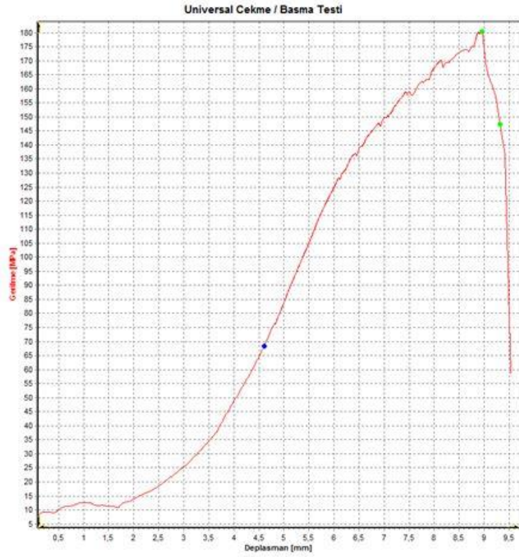
Şekil A.22 Çekme eğrisi 81 nolu numune
