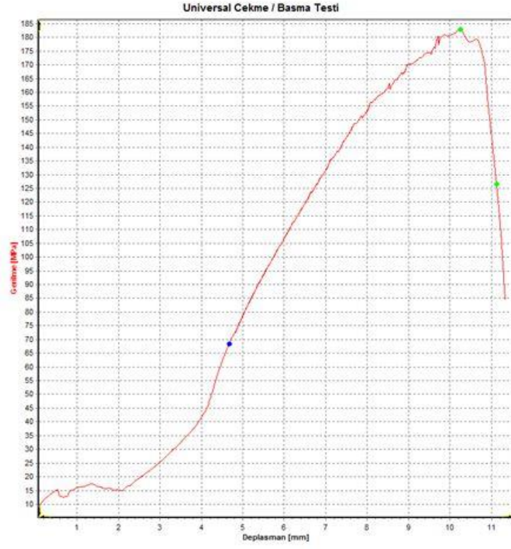
Şekil A.10 Çekme eğrisi 41 nolu numune
