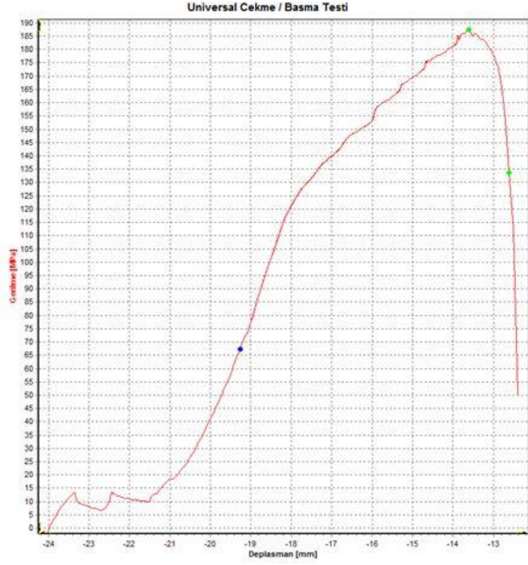
Şekil A.6 Çekme eğrisi 23 nolu numune
