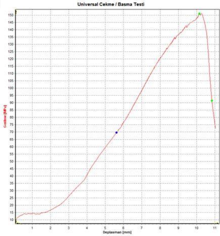
Şekil A.13 Çekme eğrisi 51 nolu numune
