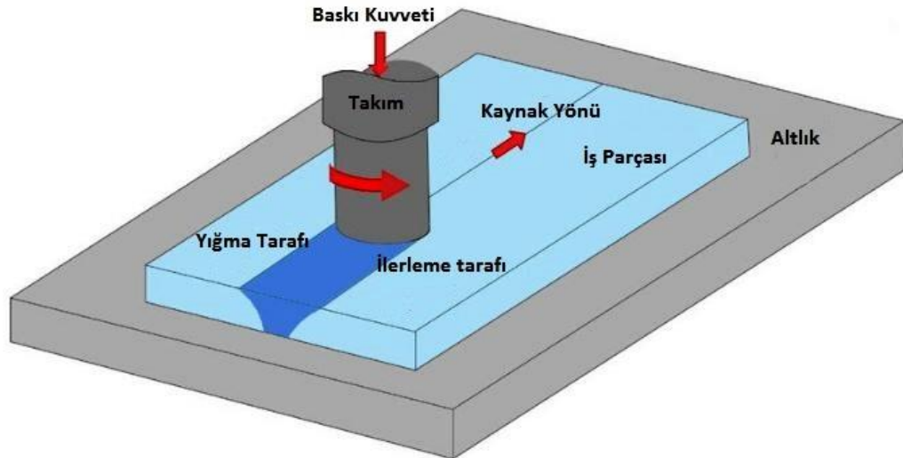
Şekil 3.2 Sürtünme karıştırma kaynağı donanımı şeması [25]
