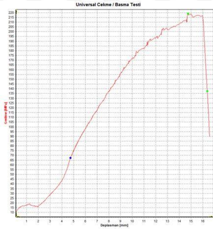
Şekil A.3 Çekme eğrisi 13 nolu numune
