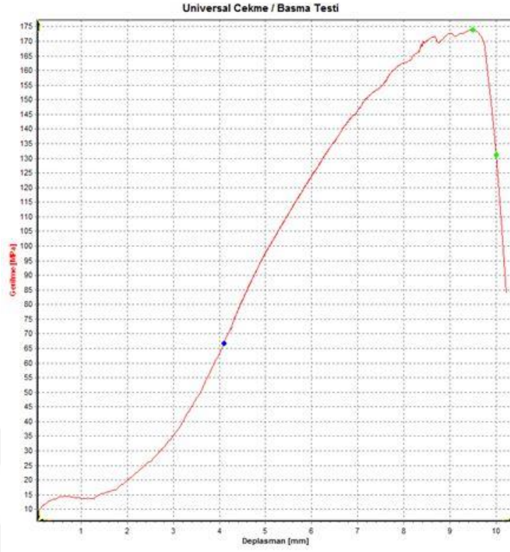
Şekil A.14 Çekme eğrisi 52 nolu numune
