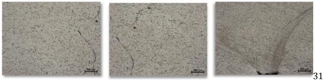
Şekil 5.5 1-9 nolu numune giriş-çıkış tarafı (ITAB-TMEB-DYKB) - 1
