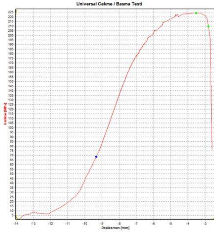
Şekil A.21 Çekme eğrisi 73 nolu numune
