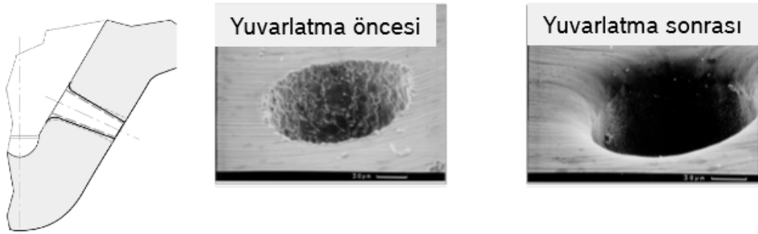
Şekil 2.10 Hidroabrasif Yuvarlatma Öncesi ve Sonrası Yüzey Görüntüsü
