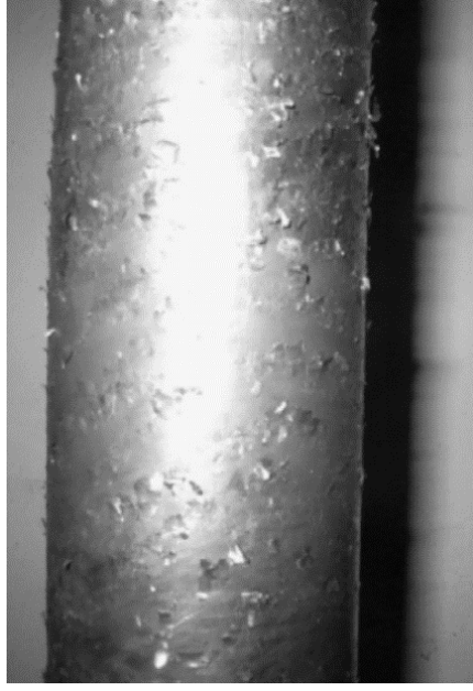
Şekil 1.1 Flowform sonrası yüzeyde pullanmalar [1]
