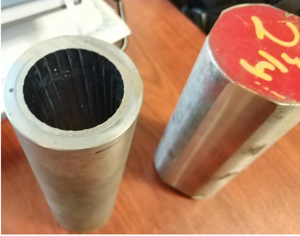
Şekil 4.3 Flowform namlusundan çekme numunesi üretim aşamaları 1
