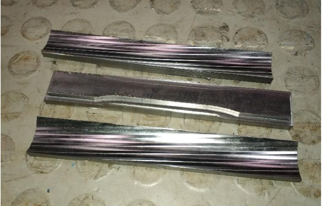
Şekil 4.4 Flowform namlusundan çekme numunesi üretim aşamaları 2
