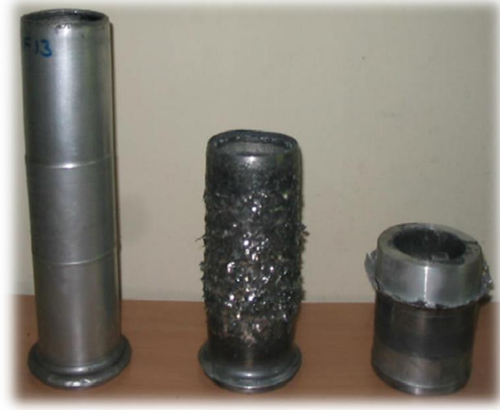
Şekil 2.8 Hatalı işlem sonucu ortaya çıkan flowform parçaları
