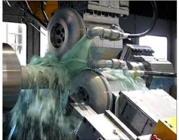
Şekil 2.6 Flowform makinesi makara grubu
