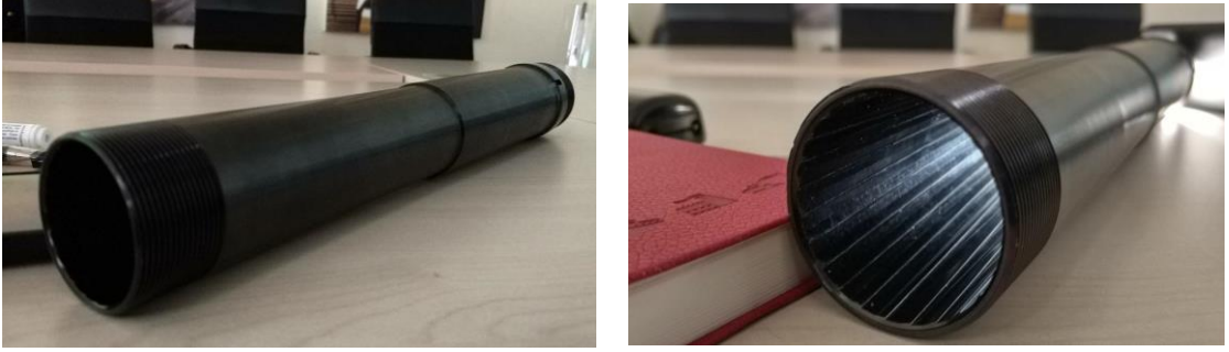
Şekil 3.7 Flowform ile üretilmiş 40mm bomba atar namlusu
