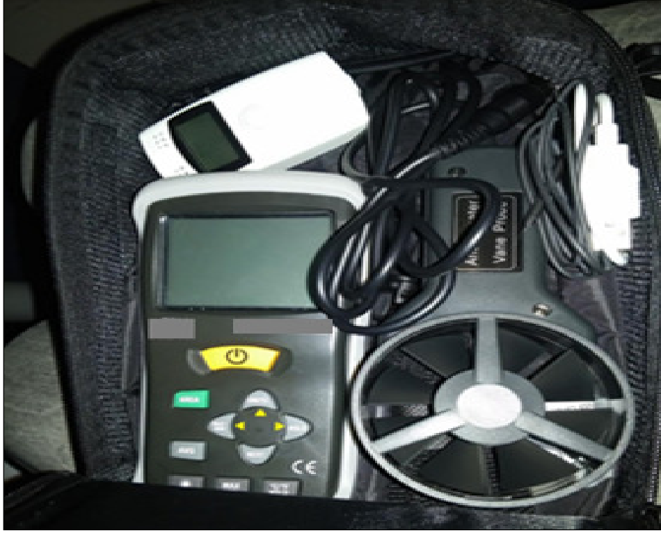
Şekil 3.4 Deneyde kullanılan dijital sıcaklık, nem kayıt cihazı ve dijital anemometre cihazı
