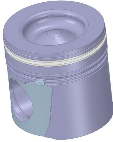
Şekil 3.2 Tasarlanan piston modelinin perspektif görünüşü
