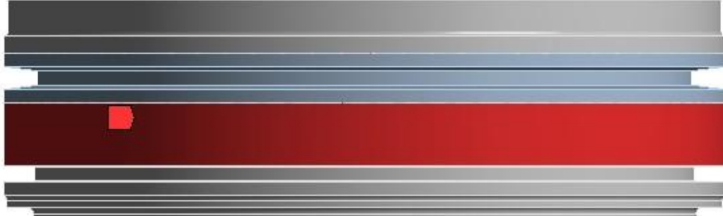
Şekil 3.15 Üst segman ile orta segman arasında kalan bölge (midland)
