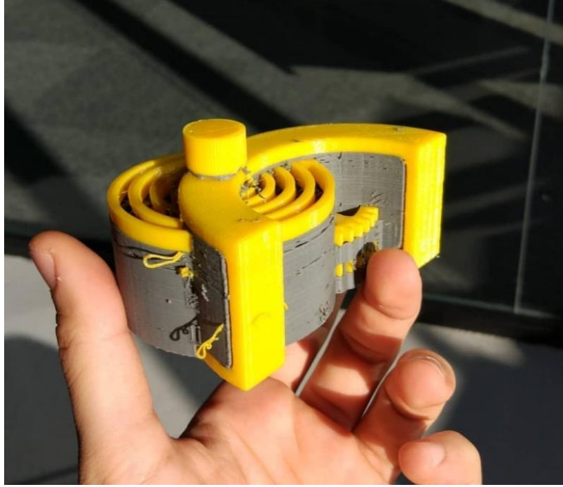
Şekil 1.7 Çözünebilir destek malzemesi ile basılan kurmalı bir mekanizma (Destek malzemesi: E3D Scaffold, Gri renkli)
