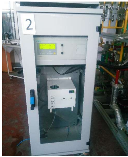
Şekil 5.2 Testlerde kullanılan baca gazı analizörü ve yardımcı ekipmanları
