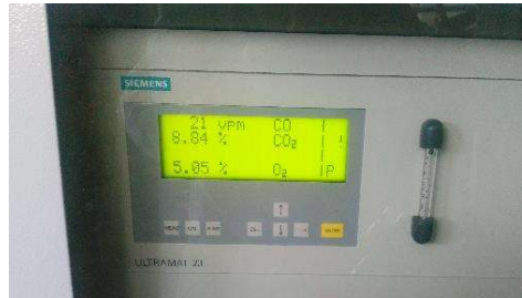
Şekil 5.3 Baca gazı analizörü ekranından bir görüntü
