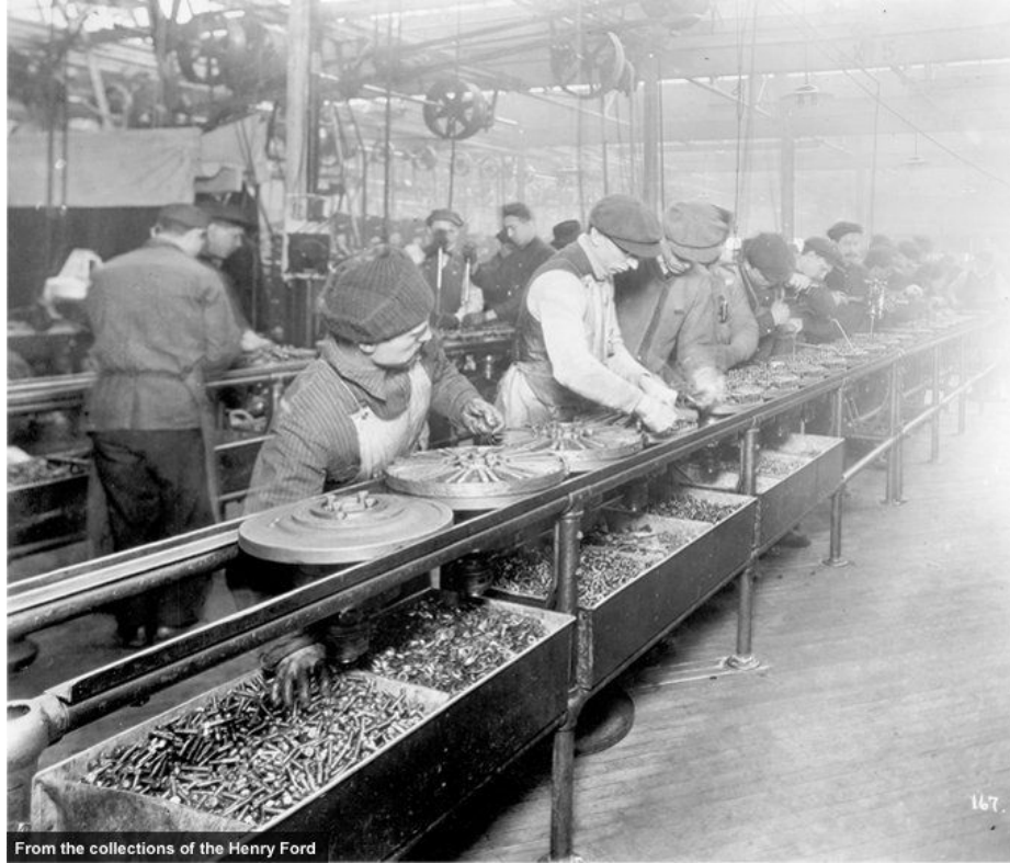
Şekil 2.13 Ford'un hareketli montaj hatlarına geçişi (Nisan 1913)
