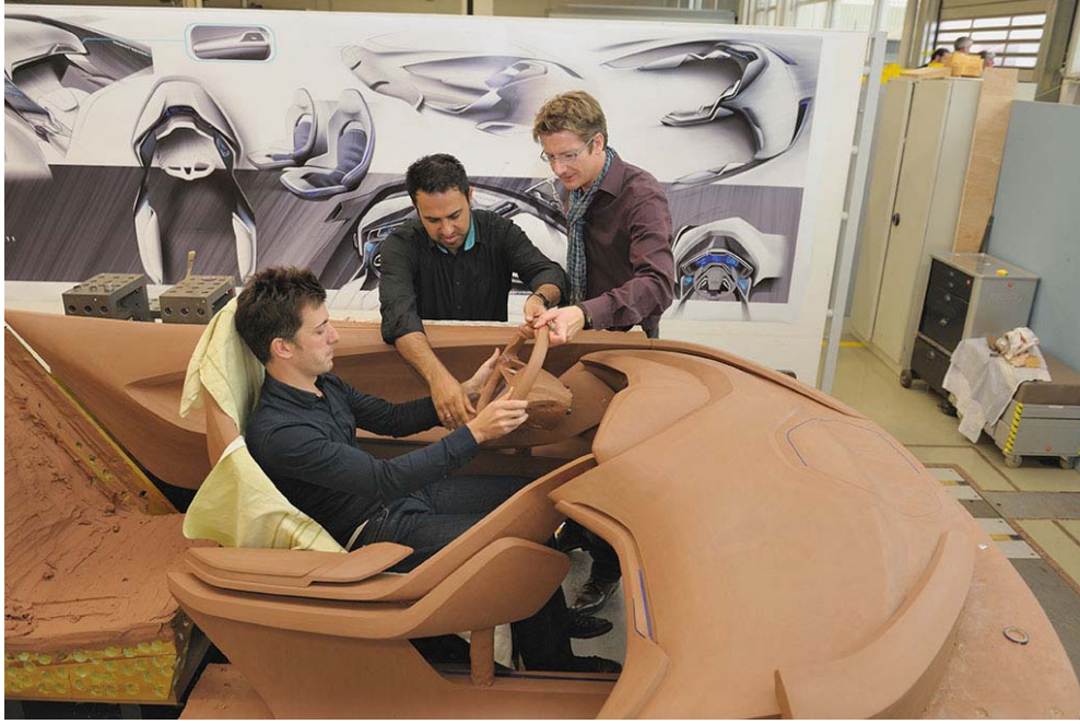
Şekil 2.32 İç tasarımda ergonomi kontrolü için kil modelin kullanılması [34]
