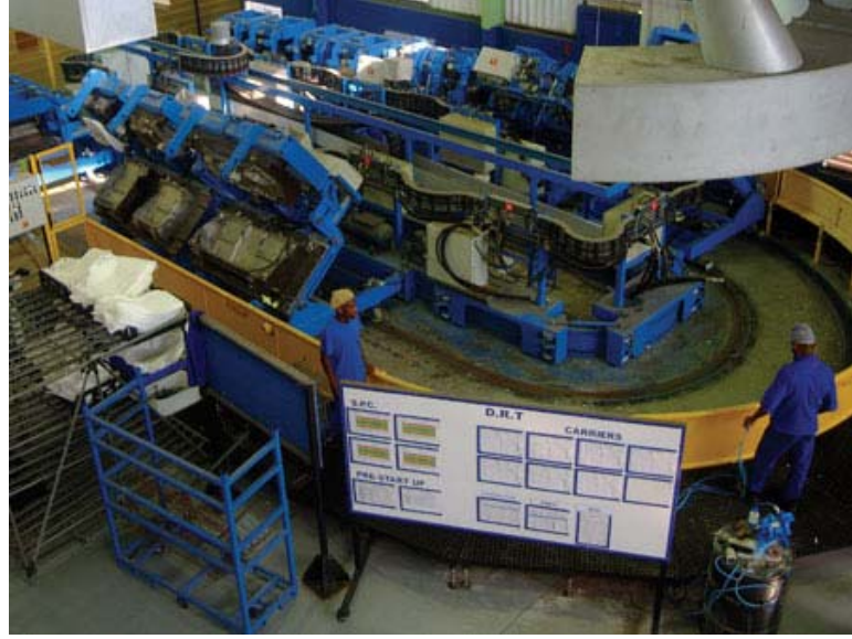
Şekil 5.25 Köpük dolgu fabrikasındaki kalıplara ait bir görünüm
