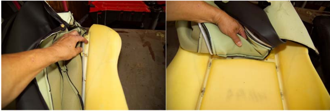
Şekil 5.24 Dolgu köpük üzerinde döşemeye ait bağlantı noktaları (hog ring)
