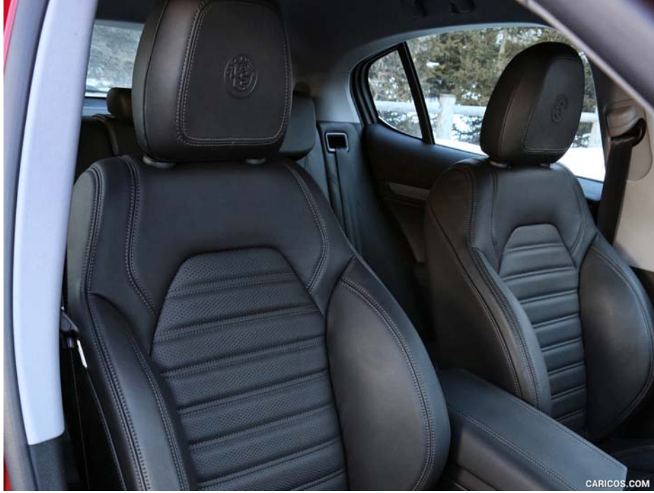
Şekil 5.31 Koltuk başlarında kabartma işlemi uygulanmış bir otomobil
