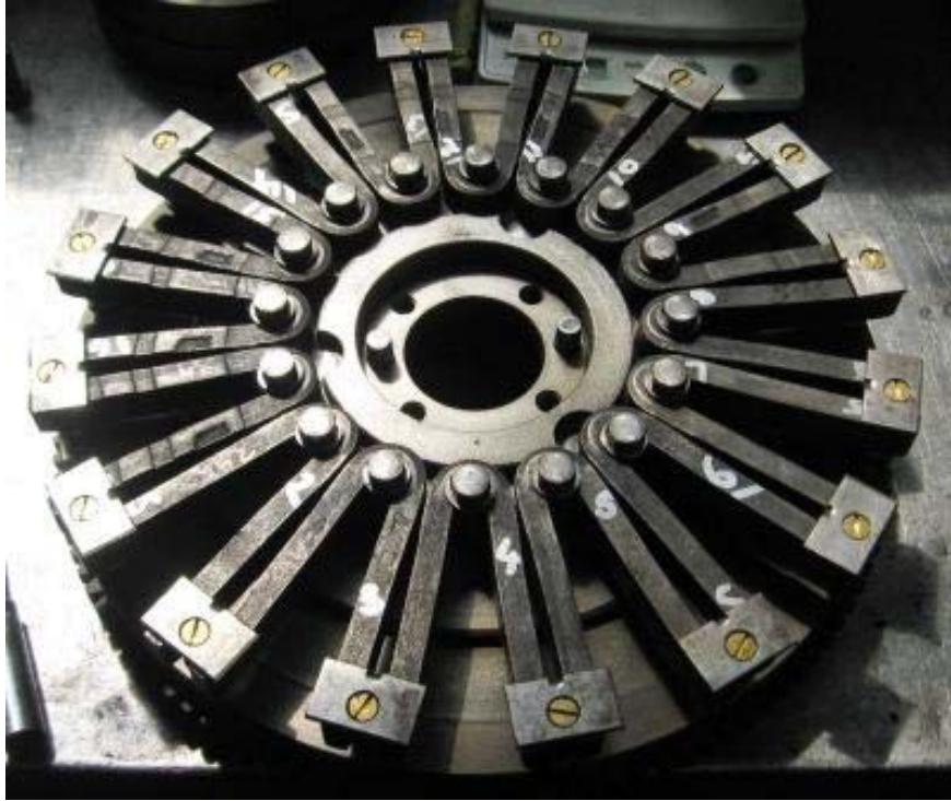
Şekil 2.12 1927 yılında üretilmiş bir Model T otomobiline ait manyeto parçası [23]
