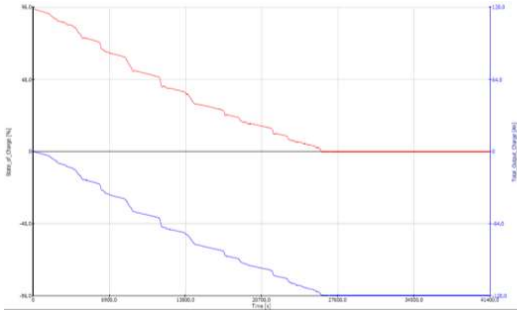
Şekil 3.3 A Aracı Bataryaya ait şarj yüzdesi ve harcadığı enerji gösterimi
