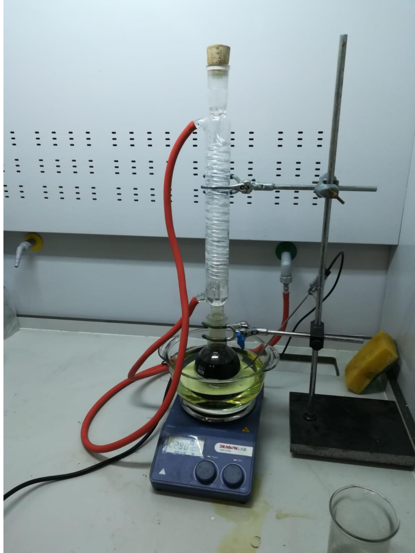
Şekil 6.4 Reflü Kondenser Sistemi
