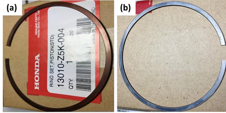
Şekil 3.4 (a) Orijinal ikinci motor segmanı Baryum (Ba) ile kaplıdır (b) İkinci motor segmanı asidik yöntem ile baryumdan arındırılmıştır.
