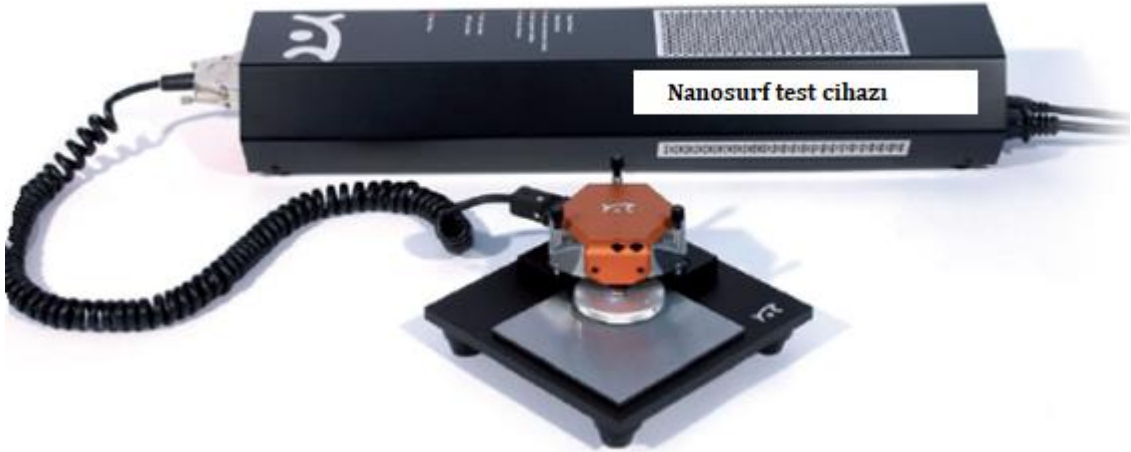
Şekil 3.2 Nanosurf easyScan 2 AFM test cihazı
