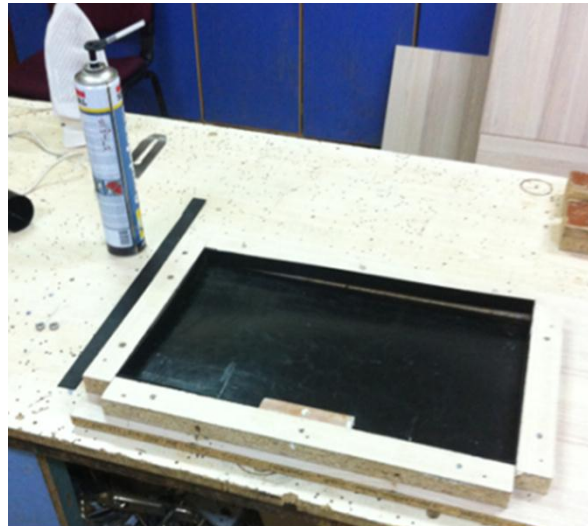
Şekil 6.10 Kovan ön duvar kalıbı
