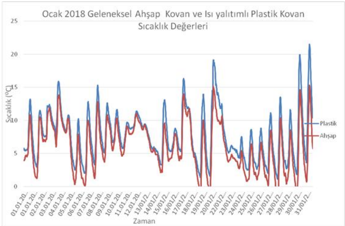
Şekil 8.26 Geleneksel ahşap kovan ve mobil arıcılığa uygun ısı yalıtımlı arı kovanı Ocak 2018 sıcaklık karşılaştırması
