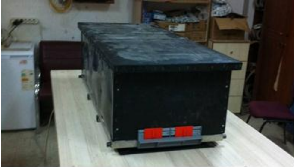
Şekil 6.12 Montajı tamamlanan mobil sisteme uygun ısı yalıtımlı arı kovani
