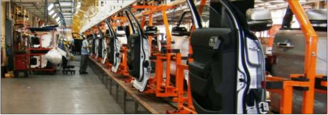
Şekil 2.1 Montaj yapılan tesiste kullanılan konveyör sistemi [15]
