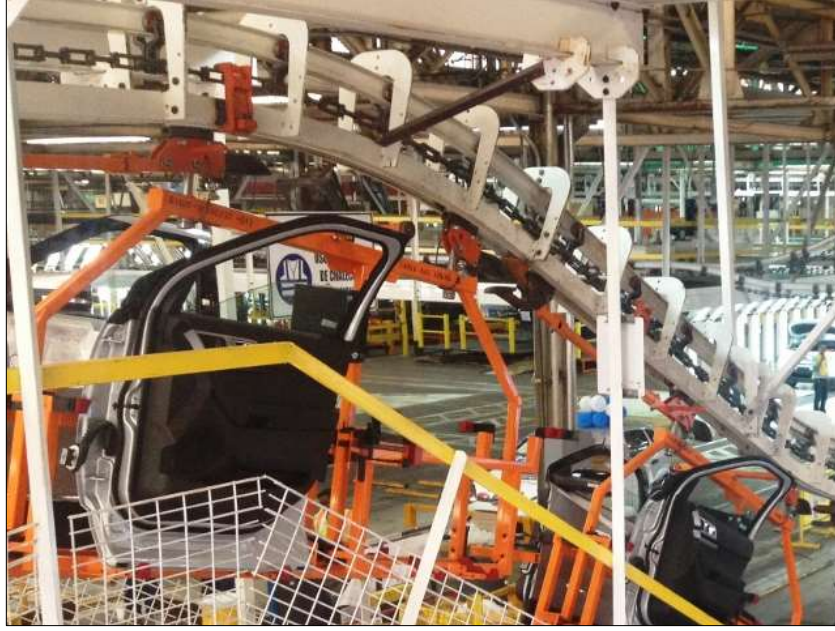
Şekil 2.6 Ford Motor montaj fabrikasındaki Power & Free konveyör [22]
