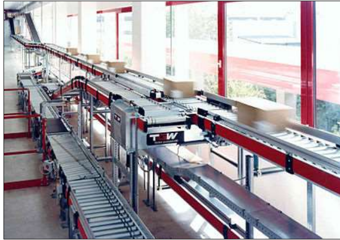
Şekil 2.3 Kartonları taşımak için kullanılan makaralı konveyör [17]
