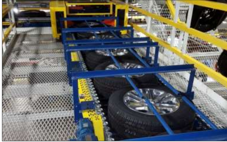
Şekil 2.4 GM montaj tesisinde makaralı konveyör [19]
