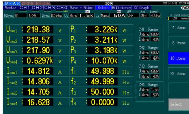
Şekil 6.23 Paralel inverter sisteminde akım, gerilim, güç ve frekans ölçümleri
