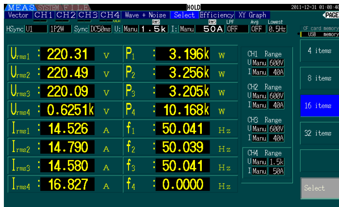
Şekil 6.29 Tek inverter şebeke akım, gerilim, güç ve frekans değerleri ( f_{sw}=9\text{kHz} )
