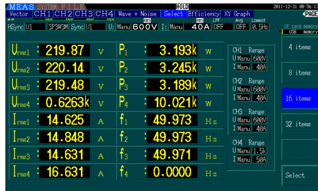
Şekil 6.17 Ana inverter akım, gerilim, güç ve frekans değerleri ( f_{sw1}=3kHz )
