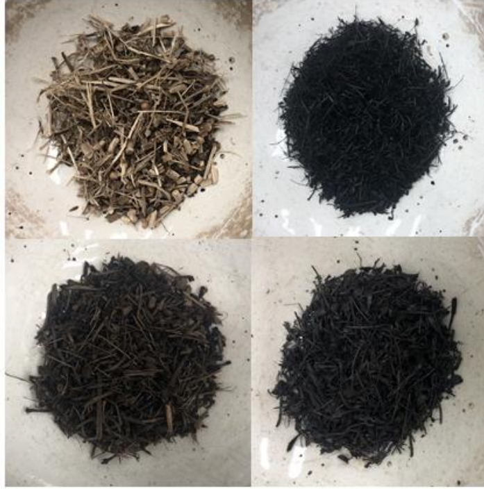
Şekil 7.5 Ham biyokütle ve değişik proses koşullarında üretilen torrefiye biyokömür numuneleri
