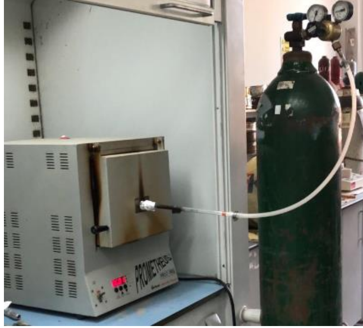
Şekil 7.4 İnert azot gazı ortamında uygulanan torrefaksiyon proses düzeneği
