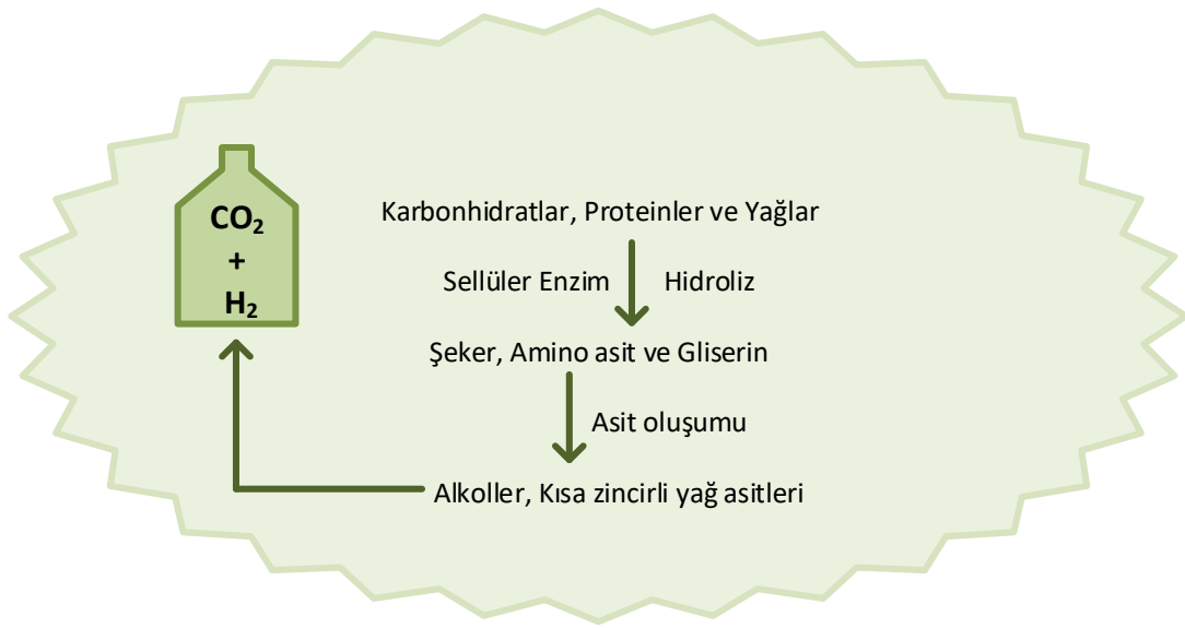
Şekil 4.2 Anaerobik çürütme prosesinin ilk aşaması (hidrojen üretimi)
