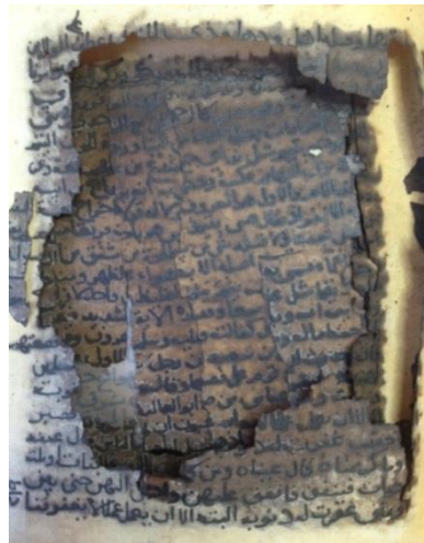
Şekil 2. 7 Demir mazı mürekkebi korozyonlu yazma eser (Millet Yazma Eser Kütüphanesi- Feyzullah Efendi Koleksiyonu No:1697)
