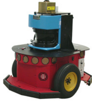
Şekil 4. 13 Pioneer P3-DX robot
