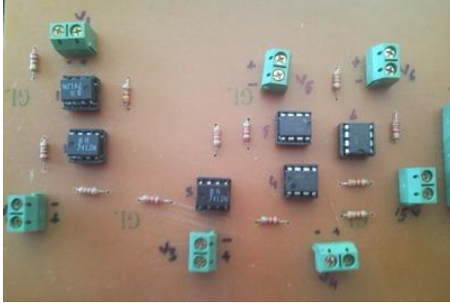
Şekil 5.5 IGBT kontrol devresinin karta basılmış hali
