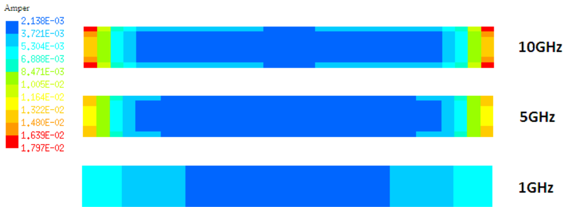
Şekil 4.20 Değişen frekanslar için 32x8 parçaya ayrılmış kesitlerde yaklaşmanın akım dağılımına etkisi
