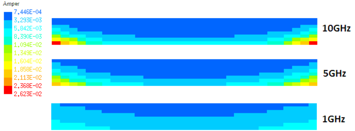
Şekil 4.21 Değişen frekanslar için 32x8 parçaya ayrılmış kesitlerde deri ve yaklaşma etkisinin oluşturduğu akım dağılımı
