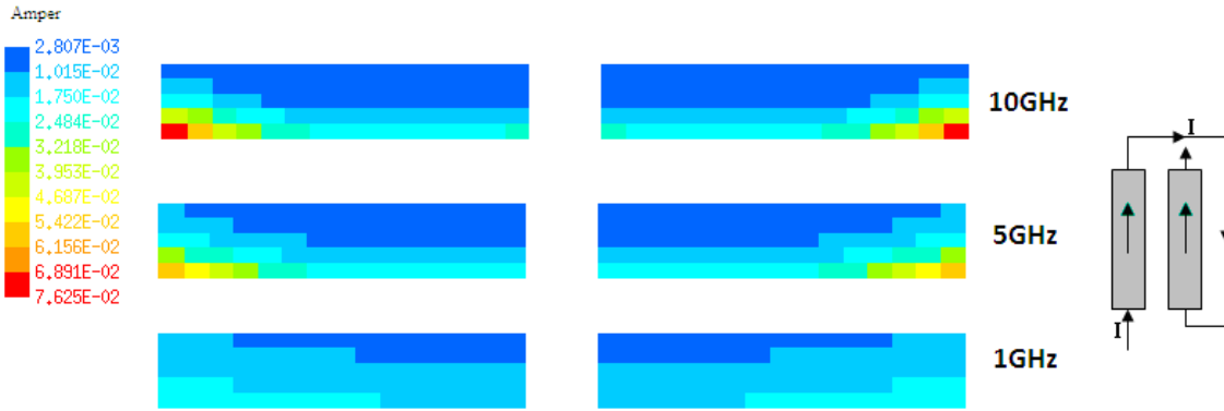
Şekil 4.23 İki iletken hat üzerinde deri ve yaklaşma etkilerinin (15x5 parçaya ayrılmış) kesitte oluşturduğu akım dağılımı
