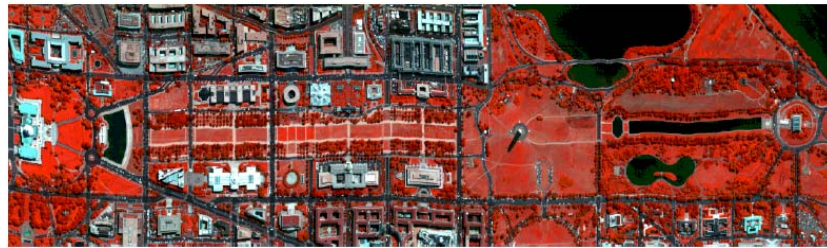
Şekil 2.4 HYDICE Washington DC Mall verisinin görüntü uzayında RGB üç kanal yapay görüntüsü (kullanılan bantlar R:60, G:27, B:17 -210 band için-)
