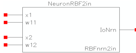
Şekil 4.9 2-girişli nöron devresinin blok şeması
