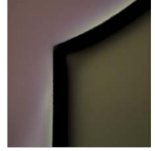
ICP aındırma sonrası PR ile yumuatılmış yzey
