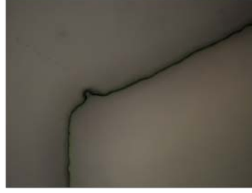
Si-altta tabanda ICP ile kuru aındırma - 50 \mu\text{m} derinlik
