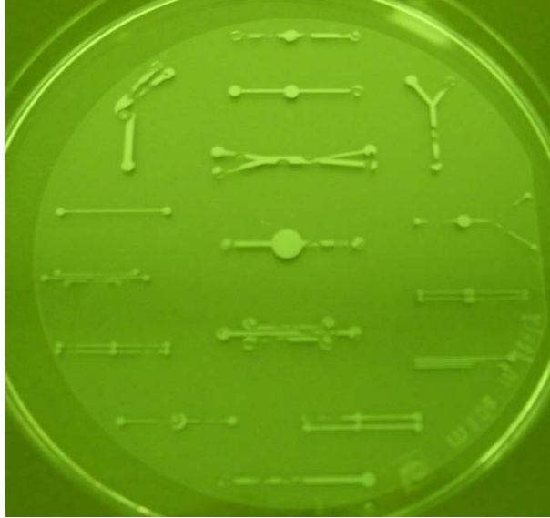
Şekil 5.6 Pyrex cam üzerine aktırdıktan sonra HF ile ıslak aşındırma işlemine sokulmuş örnek.
