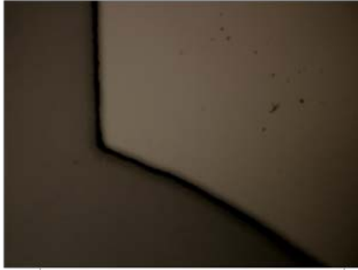
Si-altta zeri SU-8, ıslak aındırma – 60 \mu\text{m} derinlik
