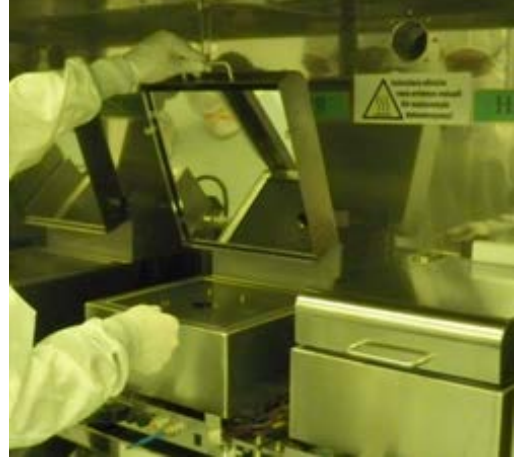
Şekil 5.4 (a) Döndürerek kaplama yapan cihaz, (b) Isıl olarak PR malzemeyi sertleştiren ısıtıcı plakalar.
