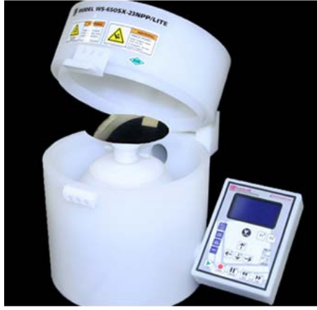
Şekil 5.4 (a) Döndürerek kaplama yapan cihaz, (b) Isıl olarak PR malzemeyi sertleştiren ısıtıcı plakalar.
