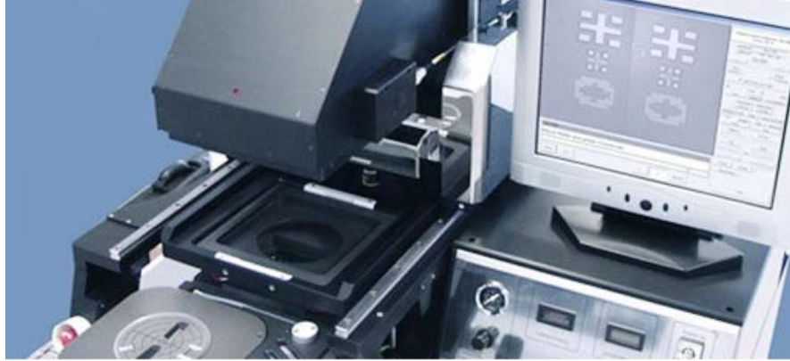
Şekil 5.3 Maske Hizalayıcısı: Hazırlanmış desenlerin kalıp tabanına fotolitografik olarak geçirilmesi işlemi. Pozlama dozları: 1500mJ - asetat üzeri desenli (Şekil 5.2 - b), 150mJ - cam üzeri krom desenli (Şekil 5.2 - c).
