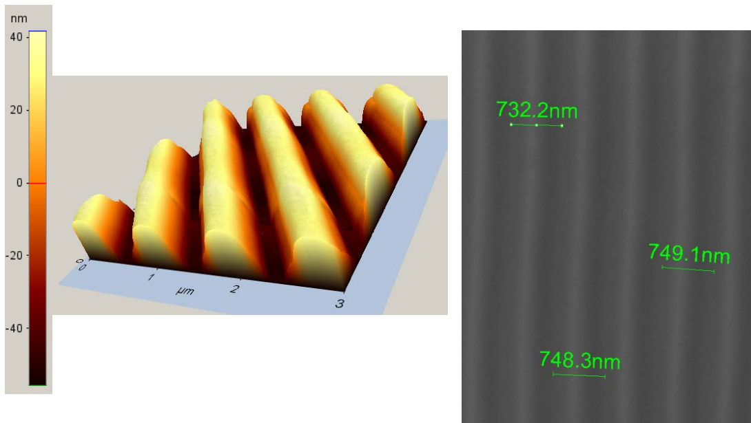
Şekil 3.1 Örnek bir kırınım ağının AFM yüzey topografisi ve SEM görüntüsü
