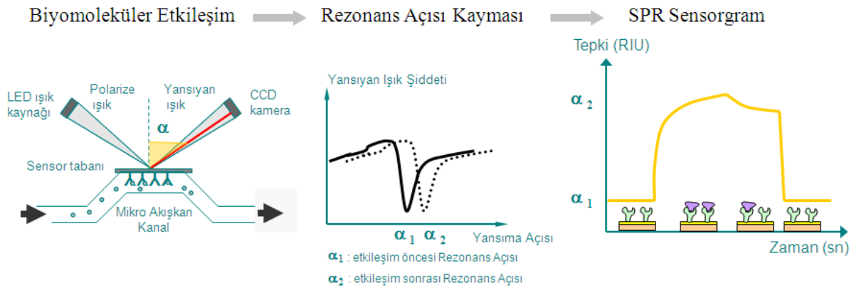
Şekil 6.4 YPR prensibine dayalı karakteristik ölçüm ve algılama metodolojisi.
