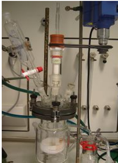
Şekil 3.2 Pes-GMA HIPE’lerin hazırlanmasında kullanılan reaktör sistemi
