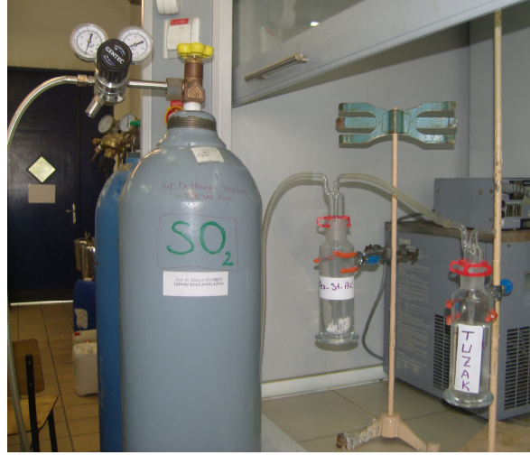
Şekil 3.1 Pes-St-AC poliHIPE kompozit polimerlerinin SO 2 adsorpsiyonunda kullanılan düzenek
