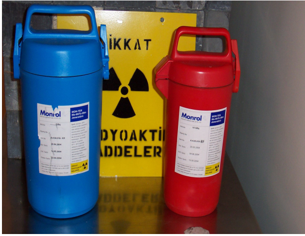
Şekil 5.1 ^{99}\text{Mo} - ^{99\text{m}}\text{Tc} jeneratörü
