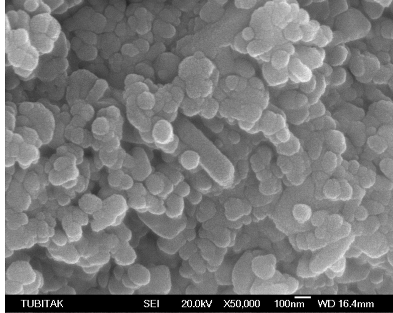
Şekil 3.11 Pd/Au/ZnO<100nm (H 2 /N 2 ) örneğine ait SEM fotoğrafı
