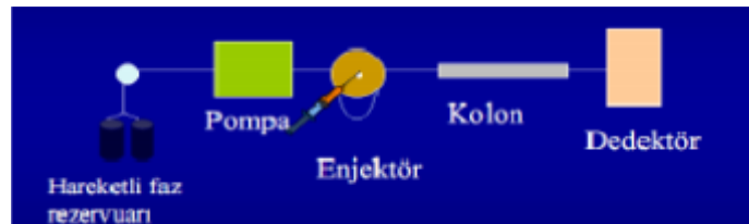
Şekil 5.3 Yüksek performanslı sıvı kromatografisi (HPLC) sisteminin şematik gösterimi [26]
