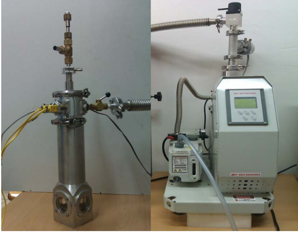
Şekil 5. 13 Kriyostat ve pompa sistemi
