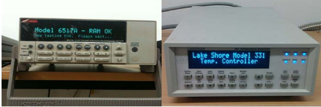
Şekil 5. 15 Deneylerde kullanılan Keithley 6517A model dijital elektrometre ve Lake Shore Model 331 Temperature Controller
