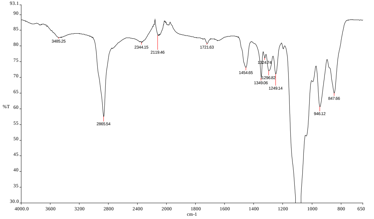
Şekil 4. 1 PEG'in FTIR-ATR spektrumu
