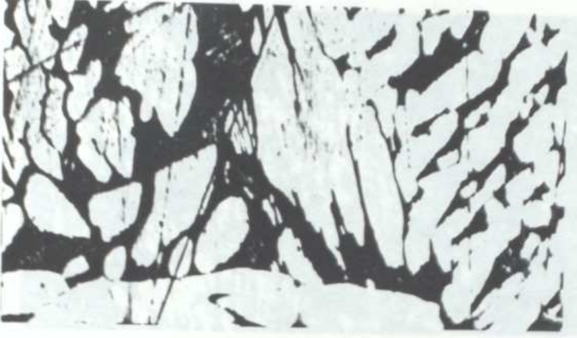
řekil-3.80 Döküm yapısı
