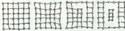
Şekil 2.5 Çözünmüş alaşım elementlerinin çökmesi
