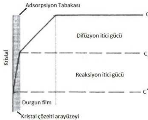
Şekil 2. 9 Kristalizasyonda konsantrasyon itici kuvvetinin etkisi [30]
