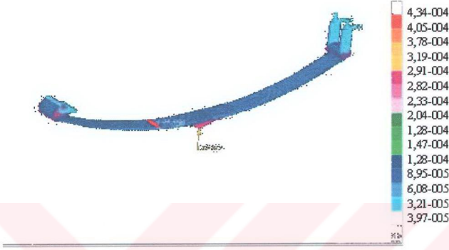
Şekil 8.34 100 daN luk yükleme durumu.
