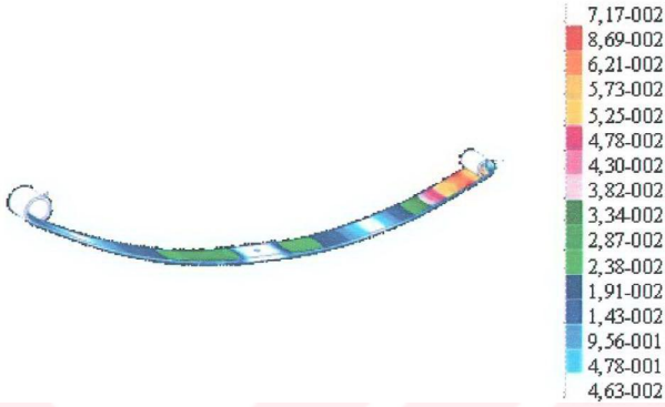
Şekil 8.38 Araç ağırlığına göre yapılan statik analiz sonucu.
