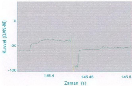
Şekil 4.1 Aks sinyali üzerindeki spike noktası
