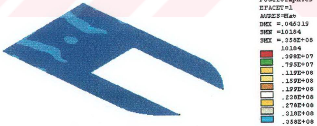
Şekil 7.5 Üst plakada oluşan eş değer gerilme dağılımı
