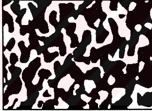
Şekil 2. 8 Self-consistent metodunun geçerli olduğu kompozit mikro yapısı (Aboudi, 1991)
