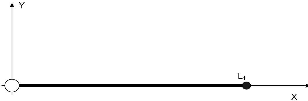
Şekil 6.3 Elastik Uzuvun t=0 ve \theta=0 daki Konumu
