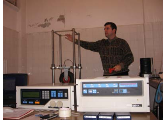
(b) Eksenel kuvvet oluşturu ekipmanları
