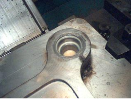
(c) Kademeli olarak işlenen delikten görüntü
