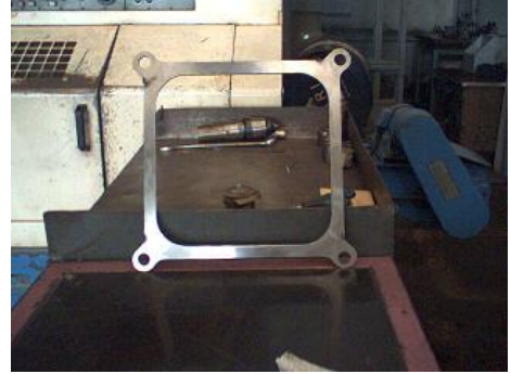
(d) Üst montaj plakasının işleme merkezinden çıkarılmış durumdaki görüntüsü
