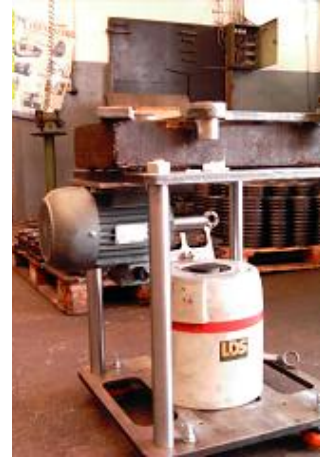
(b) Elektrik motoru ve eksenel titreşim oluşturucunun montajı
