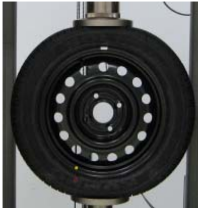
(a) Tekerlek yay gibi varsayılarak yapılan deney
