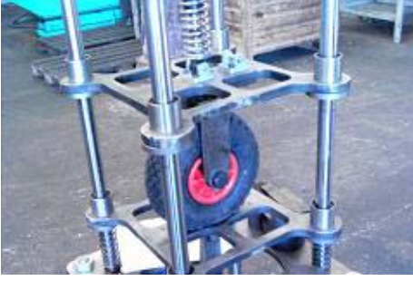
(c) Tekerleğin aks kütlesine montajı
