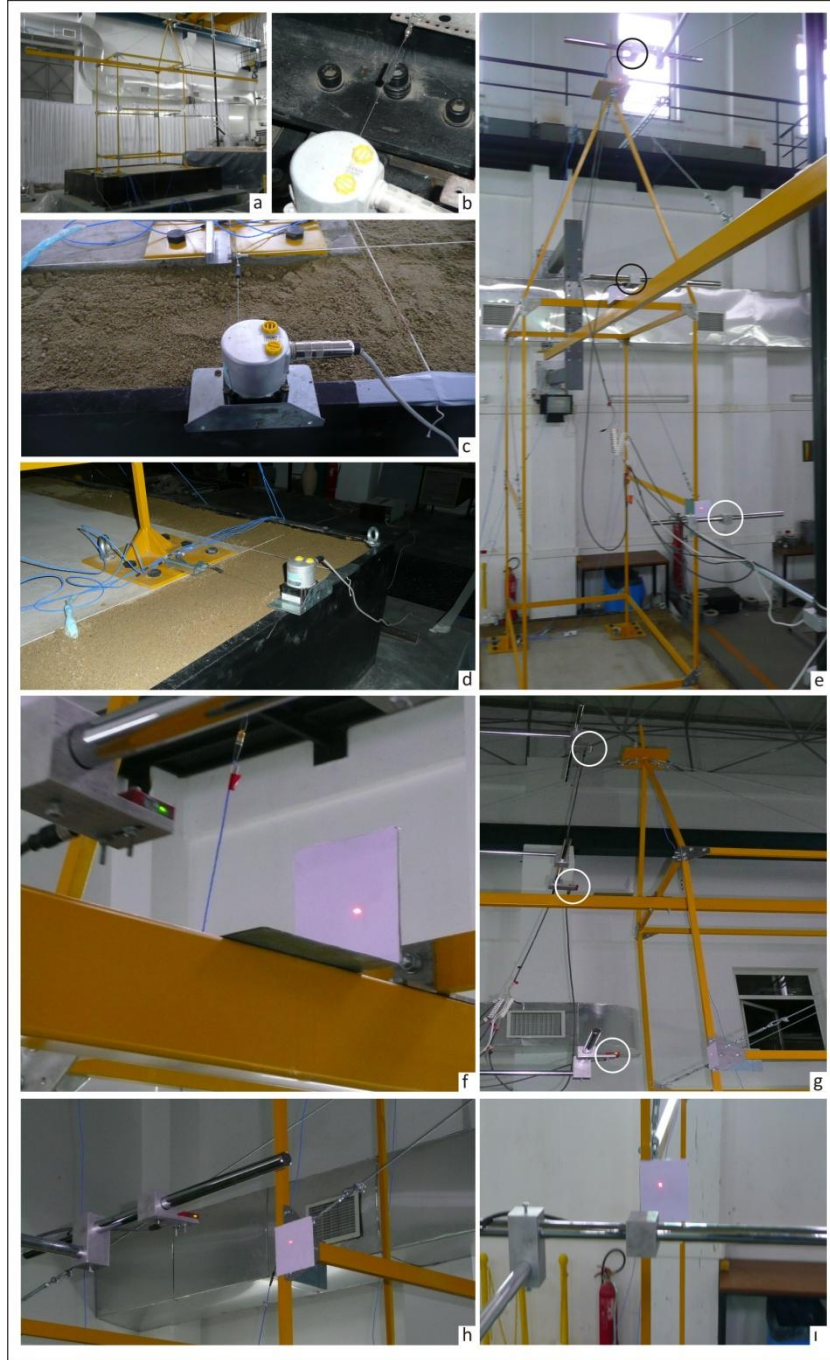
Şekil 3. 2 Deneyde kullanılan konumölçerler
