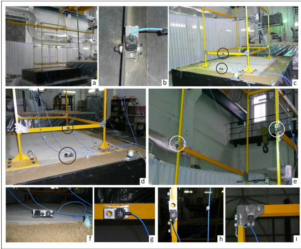
Şekil 3. 3 Deneyde kullanılan ivmeölçerler
