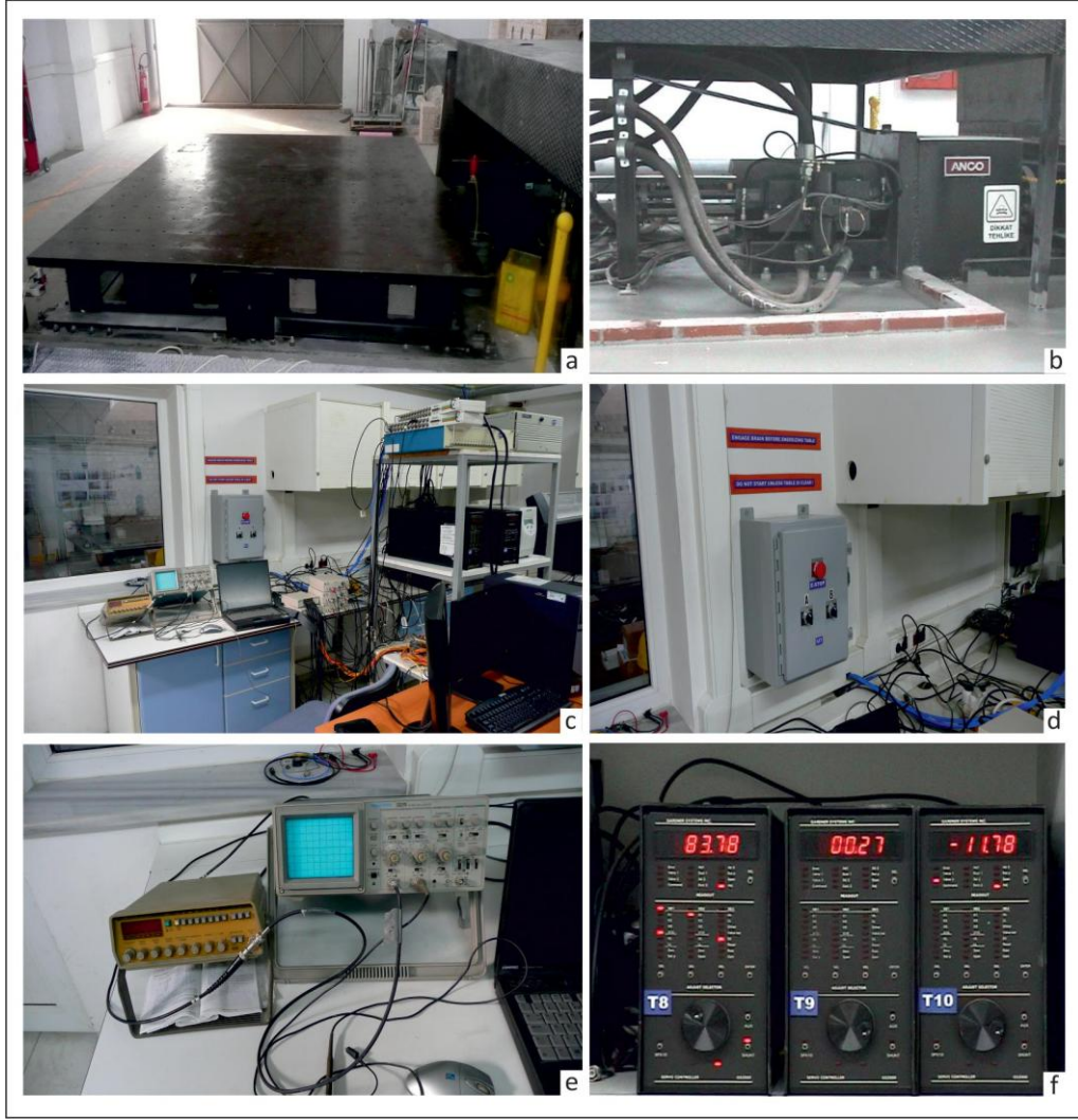
Şekil 3. 1 Sarsma masası ve kontrol ünitesi
