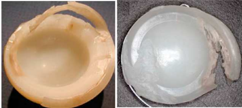
Şekil 2.18 Vücut içerisinde çıkmış, hasarlı asetabular insert örnekleri [15]
