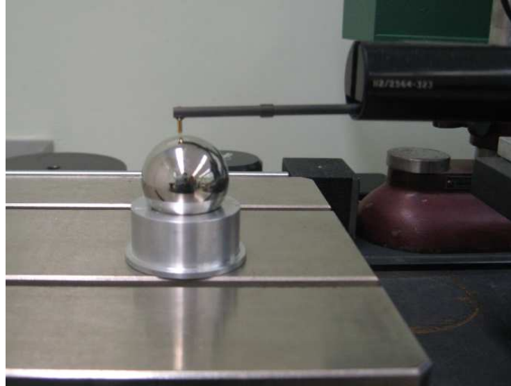
Şekil 4.19 Femur başı numunelerinin yüzey pürüzlülüklerinin ölçülmesi
