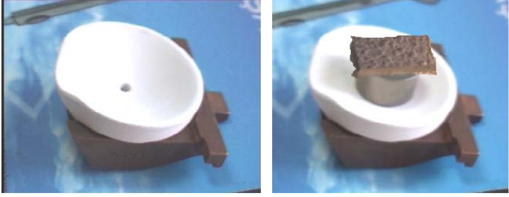
Şekil 6.6 Vakum ark ocağında kullanılan zirkonya pota ve içerisine yerleştirilen ticari saflıkta titanyum ve nikel metalleri
