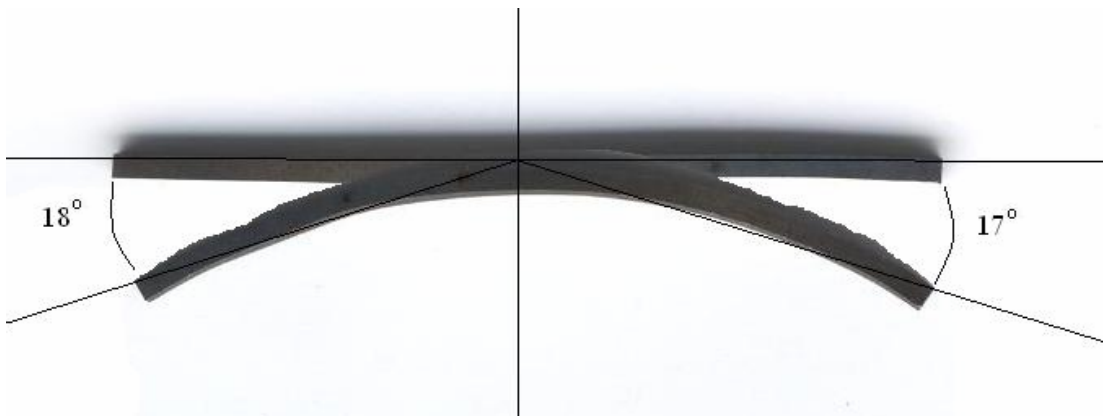
Şekil 6.63 İki uçtan toplam 110° bükülerek deformasyona uğratılan alaşımın geri dönüşümde aldığı şekil
