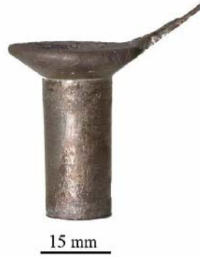
Şekil 4.7 İndüksiyon ocağında grafit potada döküm sonucu elde edilen ingot (Zhang vd., 2005)
