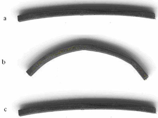
Şekil 6.53 NiTi 7-3 alaşımı üzerinde şekil bellek özelliğinin incelenmesi
