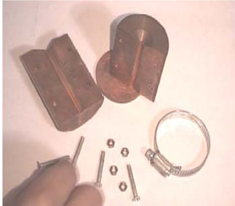
Şekil 6.7 Döküm işleminde kare prizması şeklinde ingot elde edilen bakır kalıbın ara kesitinin görünümü
