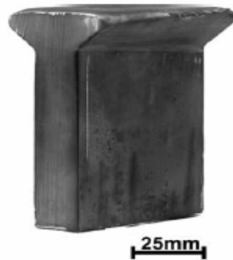
Şekil 4.6 İndüksiyon ocağında grafit potada döküm sonucu elde edilen ingot (Frenzel vd., 2004)
