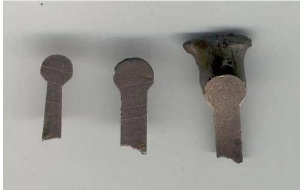
Şekil 6.31 NiTi 4-3 kodlu alaşımdan tel erozyon yöntemiyle alınan ara kesitler
