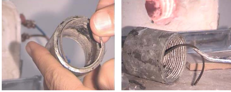
Şekil 6.11 Üretilen nikel-titanyum alaşımlardan kesilen çubuk NiTi'nin boru kalıp içerisine yerleştirilmesi
