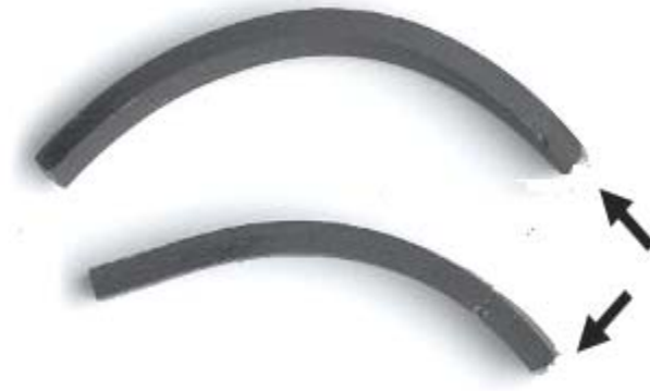
Şekil 6.64 İki uçtan toplam 115^\circ bükülmeye çalışıldığında kırılan numune
