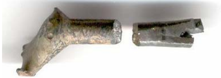
Şekil 6.30 Dövme işleminden sonra NiTi 4-3 alaşımının parçaları
