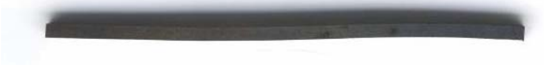
Şekil 6.10 Kalıba konularak 550°C’de 10 dakika tutulduktan sonra suda soğutma sonucu düz şekil belleği kazandırılmış nikel-titanyum alaşımı
