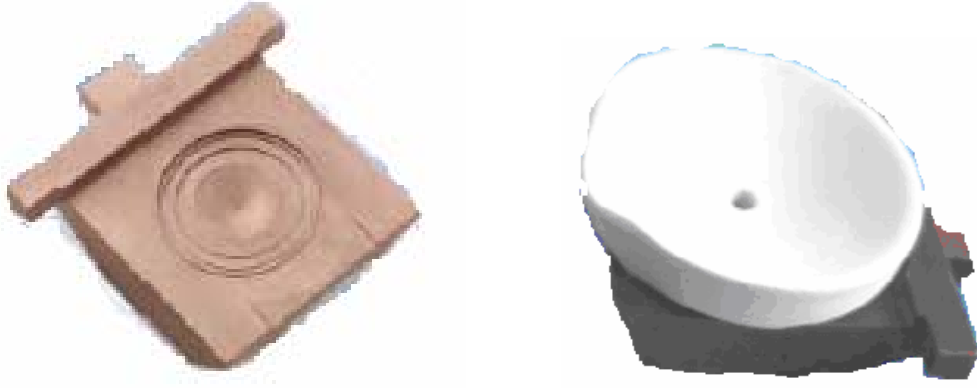
Şekil 6.4 Vakum ark ocağında dökümlerde kullanılan bakır ve zirkonya potalar
