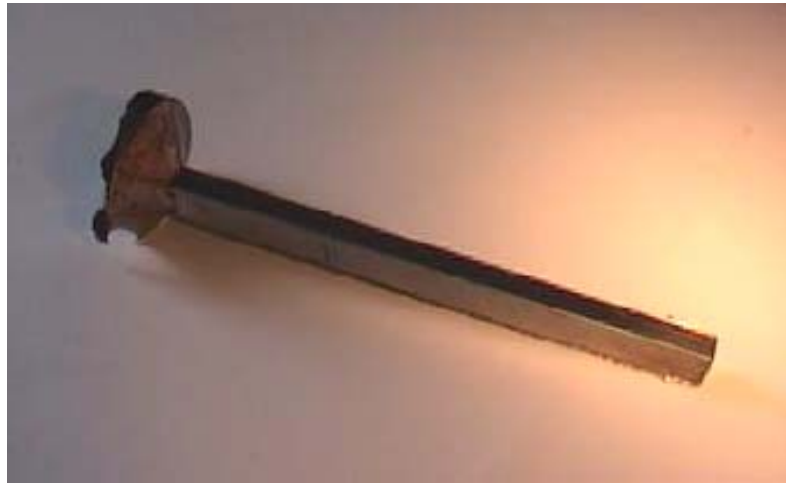
Şekil 6.20 Zirkonya potada kare prizması şeklinde üretilen NiTi 7-3 alaşımı
