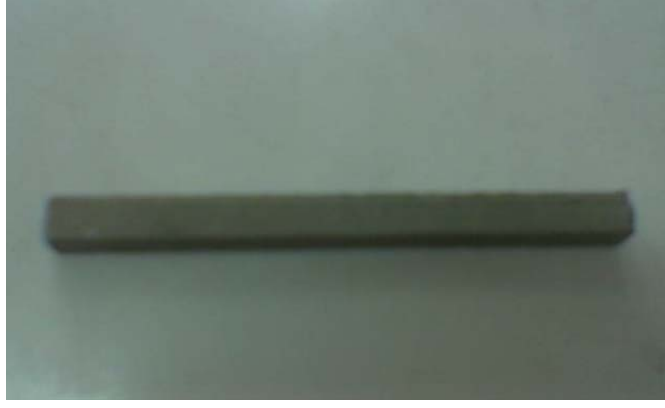
Şekil 6.26 Üst kısmı kesilerek kare prizması şeklinde kalan NiTi 12-3 alaşımı
