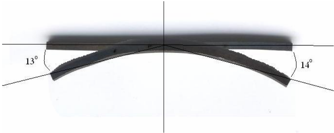
Şekil 6.61 İki uçtan toplam 100° bükülerek deformasyona uğratılan alaşımın geri dönüşümde aldığı şekil
