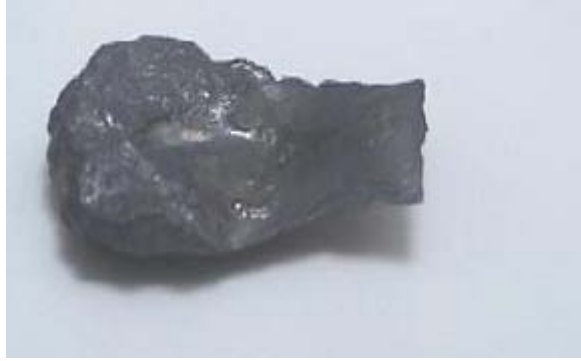
Şekil 6.12 Birinci döküm sonucunda elde edilen tam ergitilememiş NiTi 1
