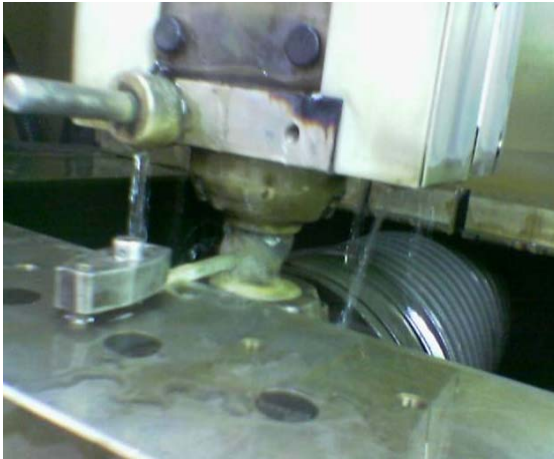
Şekil 6.25 NiTi 12-3 alaşımının Robofil 290 tel erozyon makinesi (üstte) kullanılarak tel erozyon yöntemiyle kesilmesi
