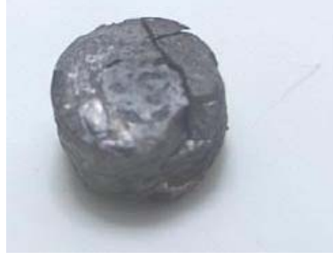
Şekil 6.18 Oksitlenerek çatlamış NiTi 6 kodlu ingot
