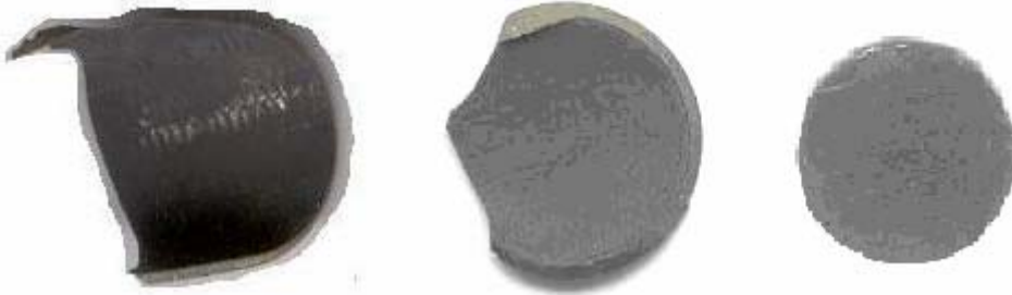
Şekil 6.28 NiTi 12-3 üst kısmından tel erozyon yöntemiyle alınan yuvarlak levha kesitler
