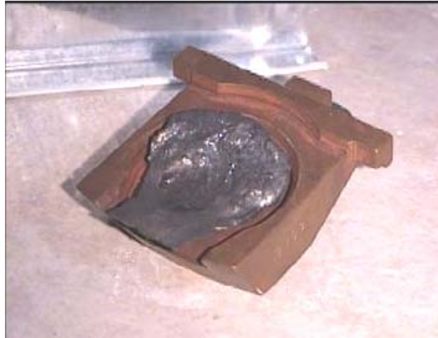
Şekil 6.13 İkinci döküm sonucunda potada kalan NiTi 2 kodlu metal
