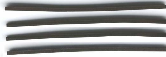
Şekil 6.27 NiTi 12-3 alaşımından tel erozyon yöntemiyle kesilerek 2mm.x2mm.x65mm. boyutlarına indirilen çubuk nikel-titanyum alaşımlar
