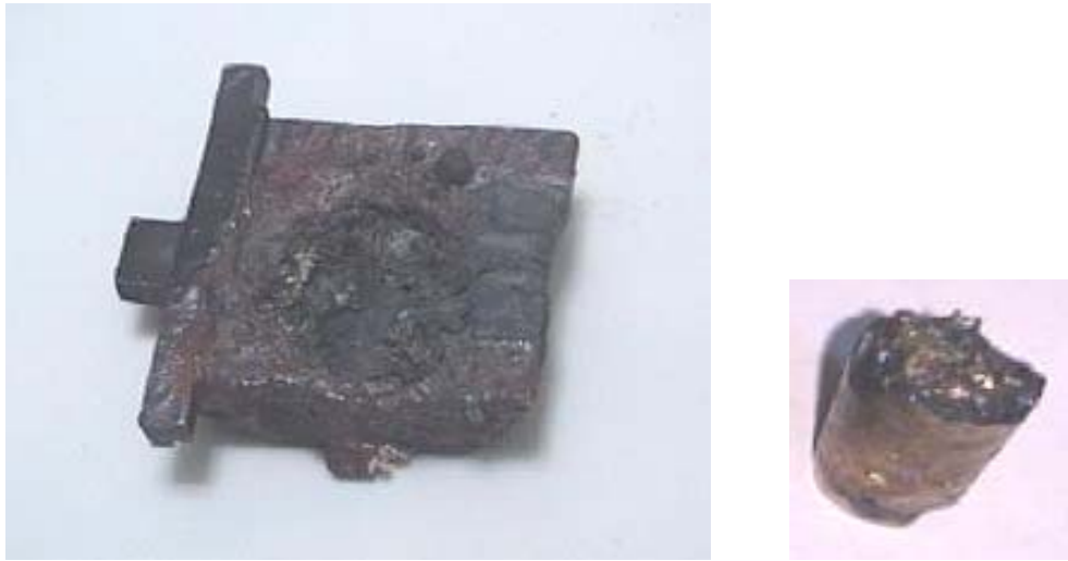
Şekil 6.17 Hasar gören bakır pota ve içerisine yüksek oranda bakır karışmış ingot
