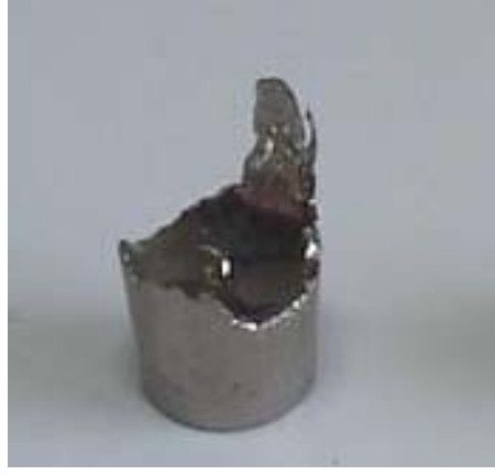
Şekil 6.14 Üçüncü döküm sonucu elde edilen konik şeklindeki NiTi 3-2 kodlu ingot
