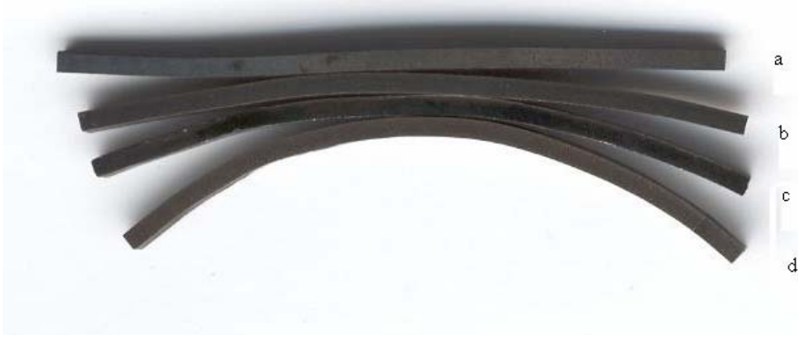
Şekil 6.70 230°C 'de (b) 330°C'de (c) 430°C'de (d) ısıtılması sonucu ilk bellek şekline dönüş oranları
