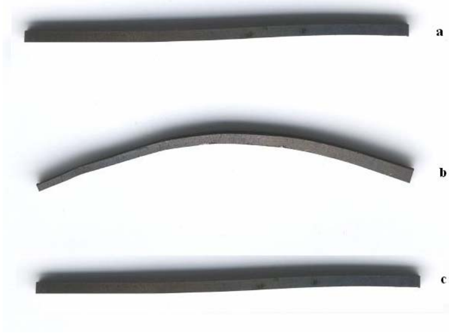
Şekil 6.49 NiTi 12-3 üzerinde şekil bellek özelliğinin incelenmesi
