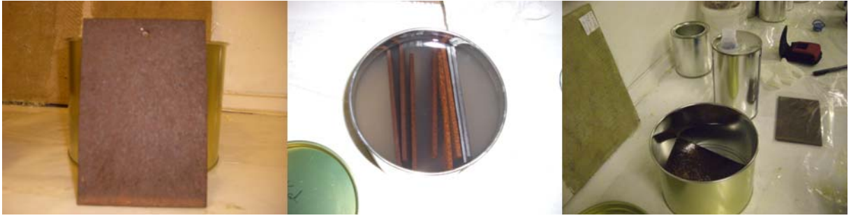
Şekil 4.4 Paslı numunelerin temizlenmesi
