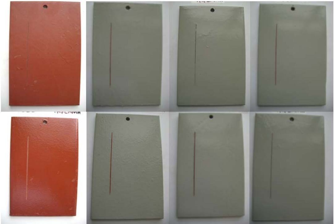
Şekil 4.6 Şahit Saha Testi Numuneleri. Taşlanmış. Sol üst köşeden sağ alt köşeye: Sistem 1, 2, 3, 4, 5, 6, 7 ve 8
