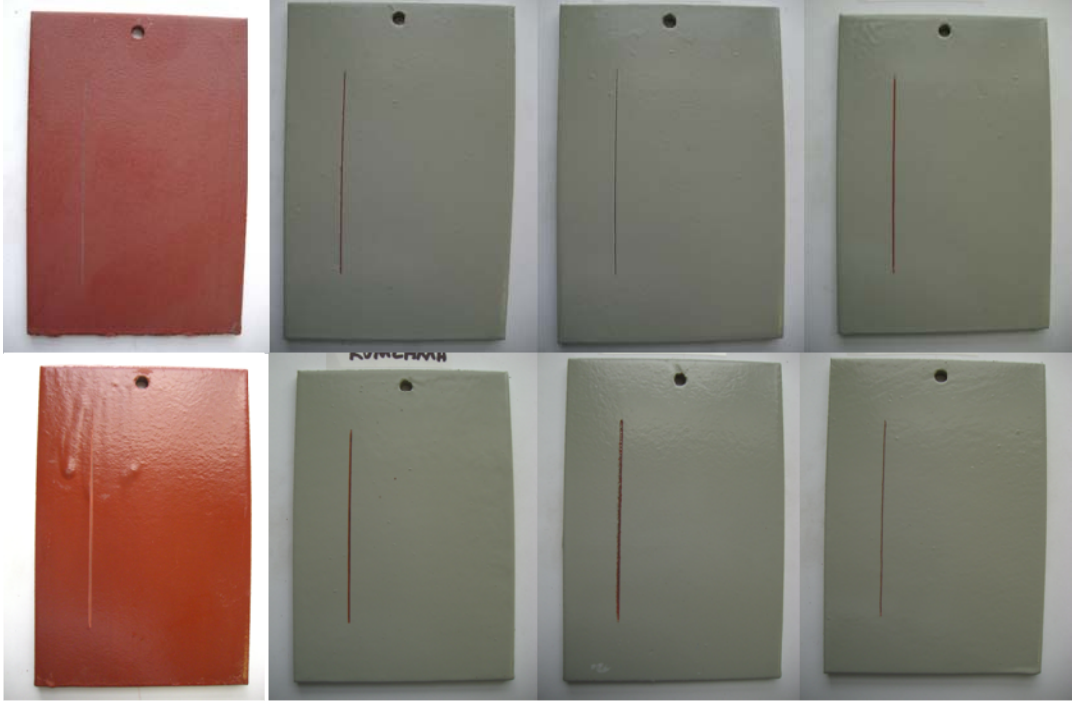
Şekil 4.5 Şahit Saha Testi Numuneleri. Kumlanmamış. Sol üst köşeden sağ alt köşeye: Sistem 1, 2, 3, 4, 5, 6, 7 ve 8
