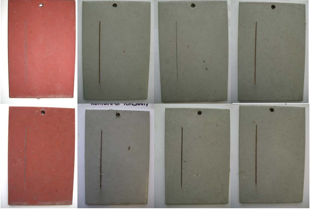
Şekil 4.11 Kalamış Saha Testi Numuneleri. Kumlanmış. Sol üst köşeden sağ alt köşeye: Sistem 1, 2, 3, 4, 5, 6, 7 ve 8
