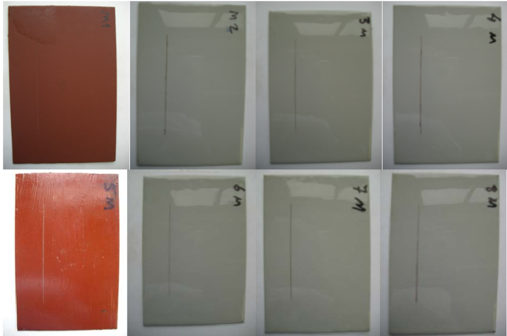
Şekil 4.14 Tuz Püskürtme Testi için Şahit Numuneler. Taşlanmış. Sol üst köşeden sağ alt köşeye: Sistem 1, 2, 3, 4, 5, 6, 7 ve 8
