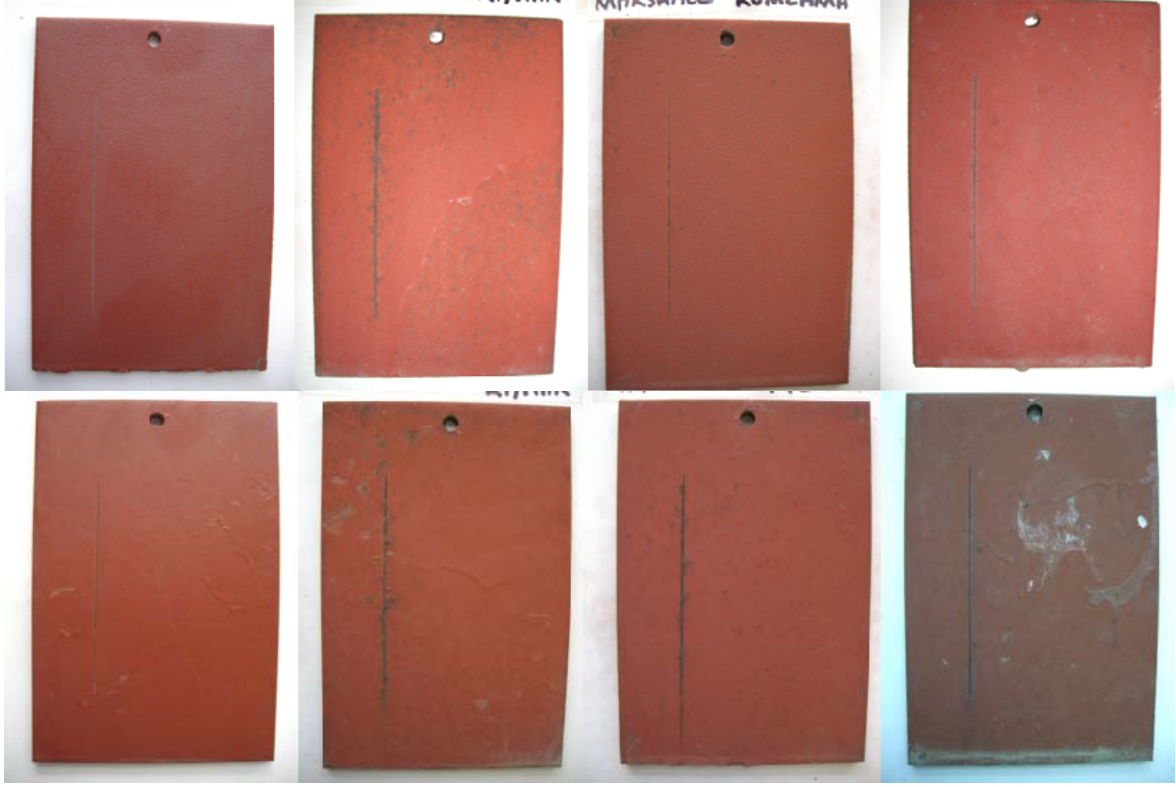
Şekil Ek1.1 Sistem 1. Üst sıra Kumlanmış, alt sıra taşlanmış. Soldan Sağa: Şahit, Kınar, Marshall, Kalamış
