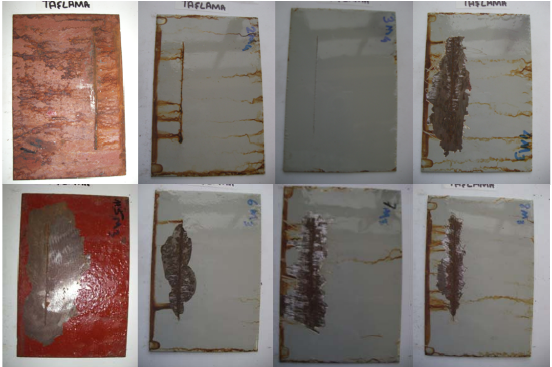
Şekil 4.18 720 Saatlik Tuz Püskürtme Testi için Numuneler. Taşlanmış. Sol üst köşeden sağ alt köşeye: Sistem 1, 2, 3, 4, 5, 6, 7 ve 8
