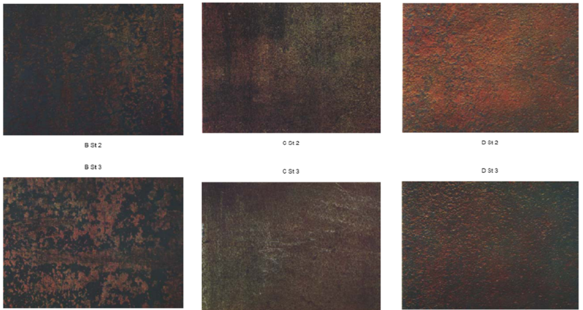
Şekil 2.25 St yüzey hazırlığı sınıfları (TSE EN ISO 8501-1, 1999)
