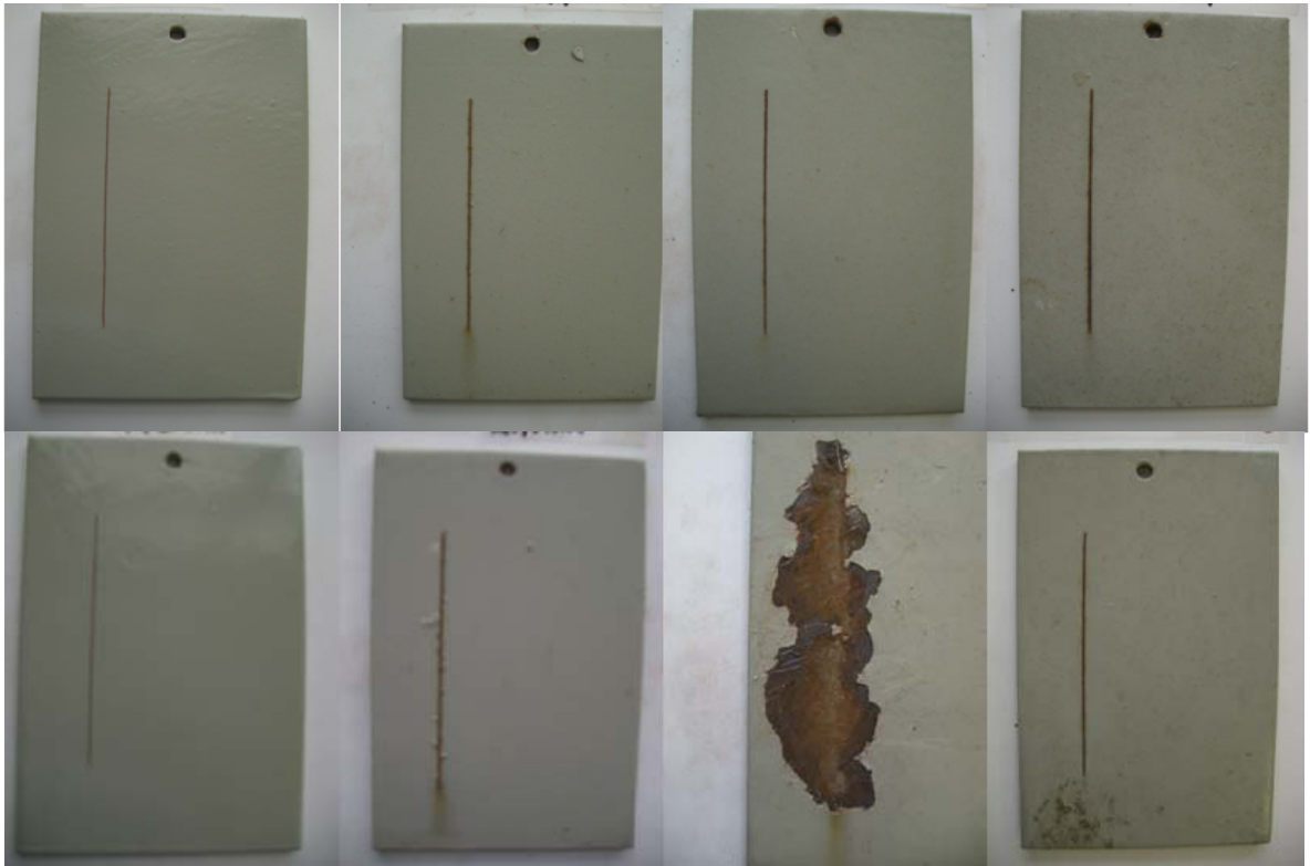
Şekil Ek 1.8 Sistem 8. Üst sıra Kumlanmıř, alt sıra tařlanmıř. So. dan Sa. ıa: řatit, Kimar, Marshall, Kalamıř
