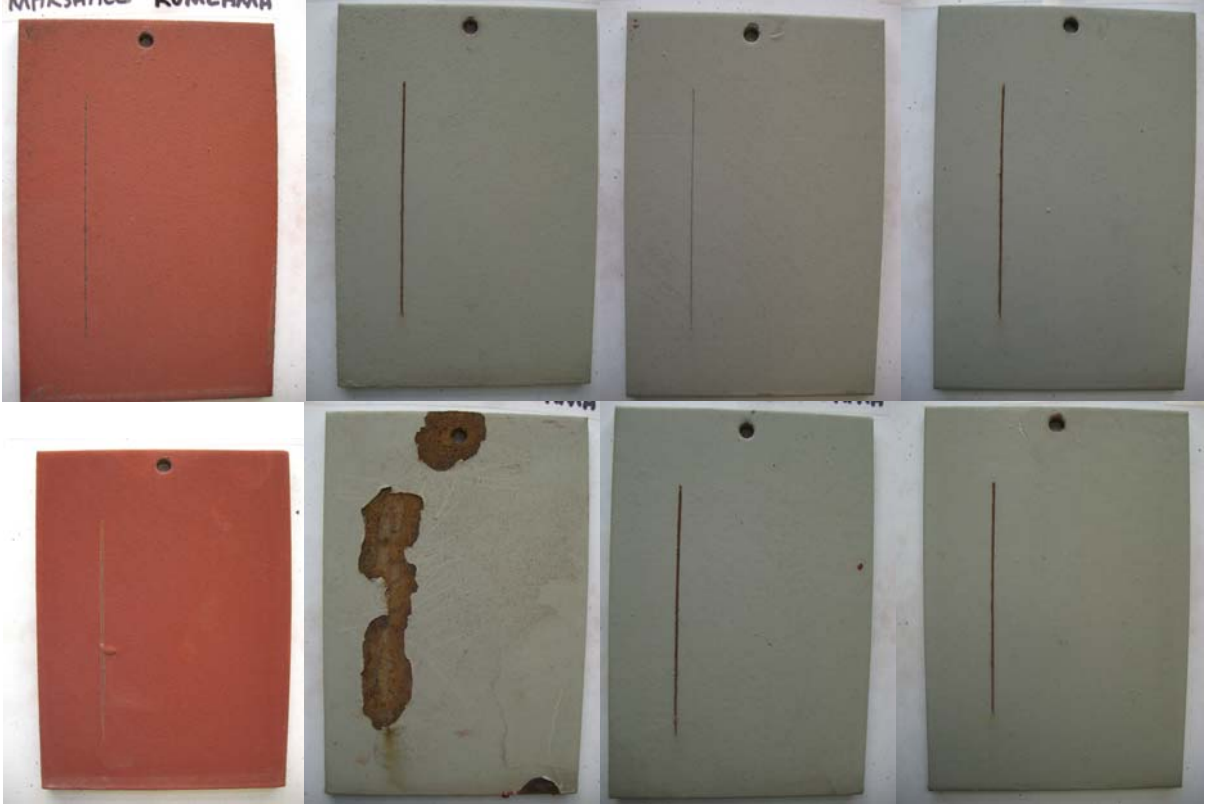
Şekil 4.9 Marshall Saha Testi Numuneleri. Kumlanmış. Sol üst köşeden sağ alt köşeye: Sistem 1, 2, 3, 4, 5, 6, 7 ve 8
