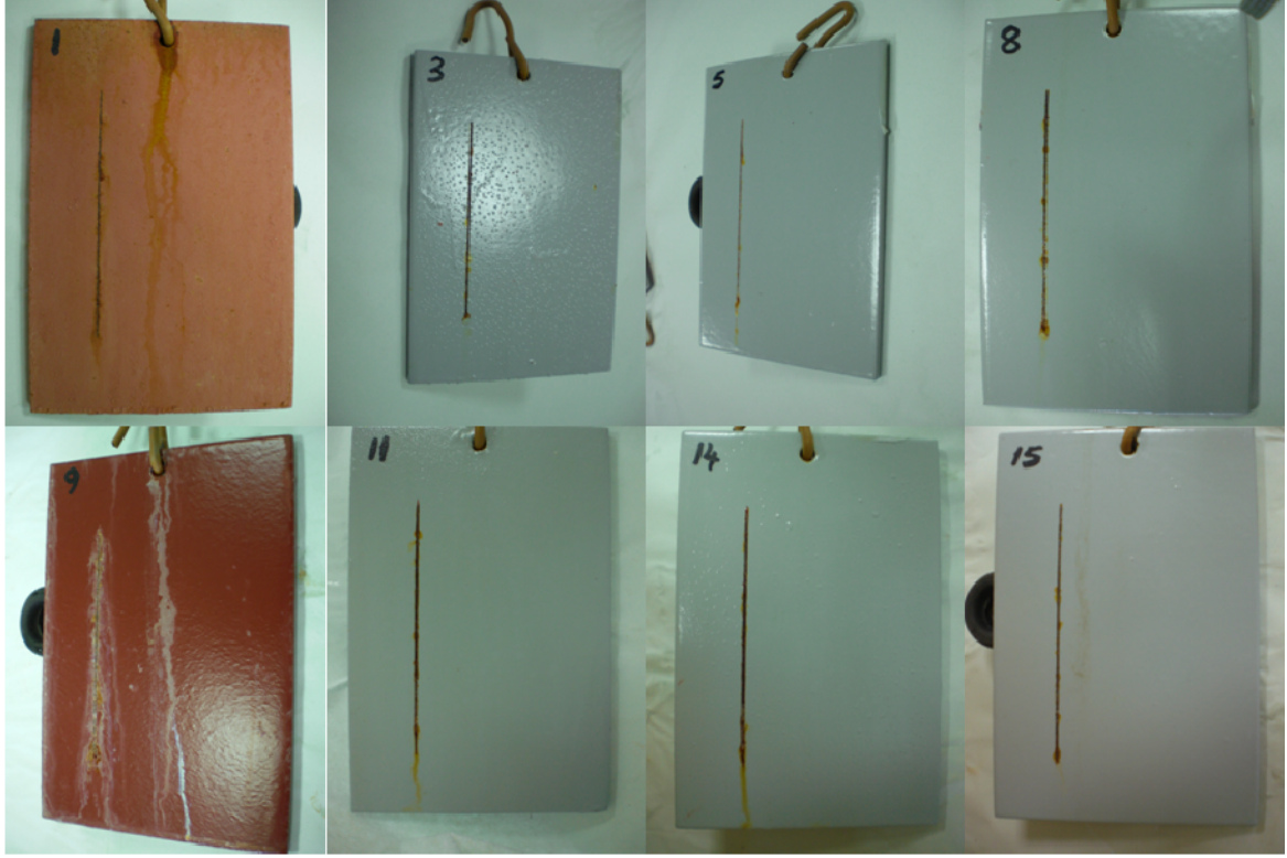
Şekil 4.23 SO 2 Testi 10. Gün. Kumlanmış. Sol üst köşeden sağ alt köşeye: Sistem 1, 2, 3, 4, 5, 6, 7 ve 8
