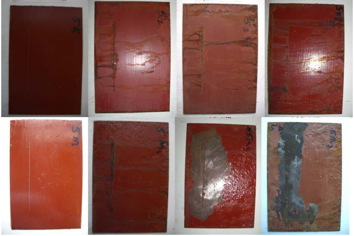
Şekil Ek 2.5 Sistem 5. Üst sıra Kumlanmış, alt sıra taşlanmış. Soldan Sağa: Şahit, 480, 720 ve 960 Saat
