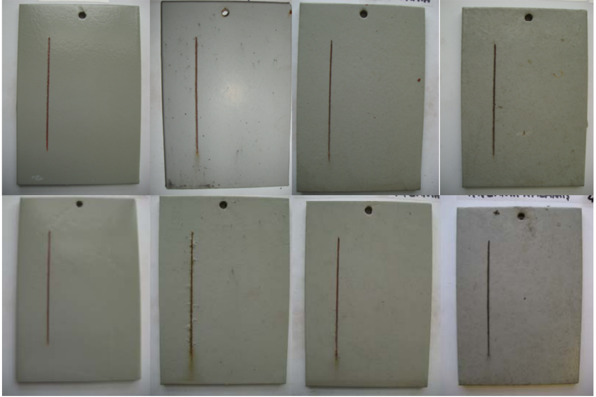
Şekil Ek 1.7 Sistem 7. Üst sıra Kumlanmıř, alt sıra tařlanmıř. So. dan Sa. ıa: řatit, Kimar, Marshall, Kalamıř
