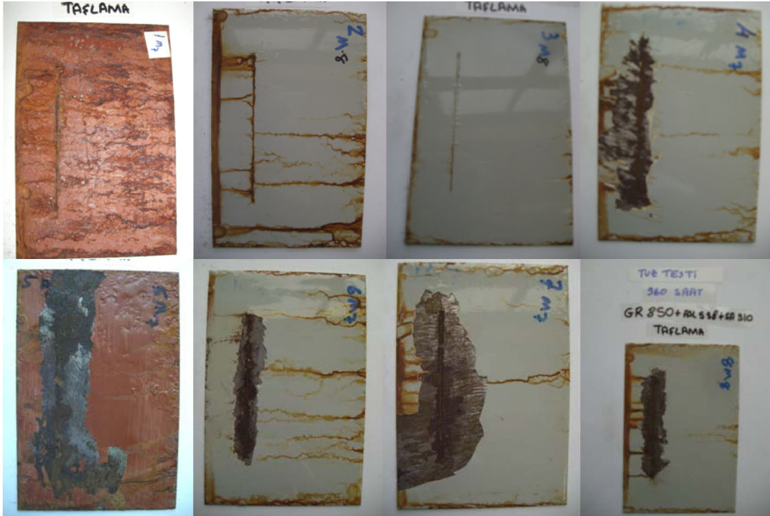
Şekil 4.20 960 Saatlik Tuz Piskürtme Testi için Numuneler. Taşlanmış. Sol üst köşeden sağ alt köşeye: Sistem 1, 2, 3, 4, 5, 6, 7 ve 8
