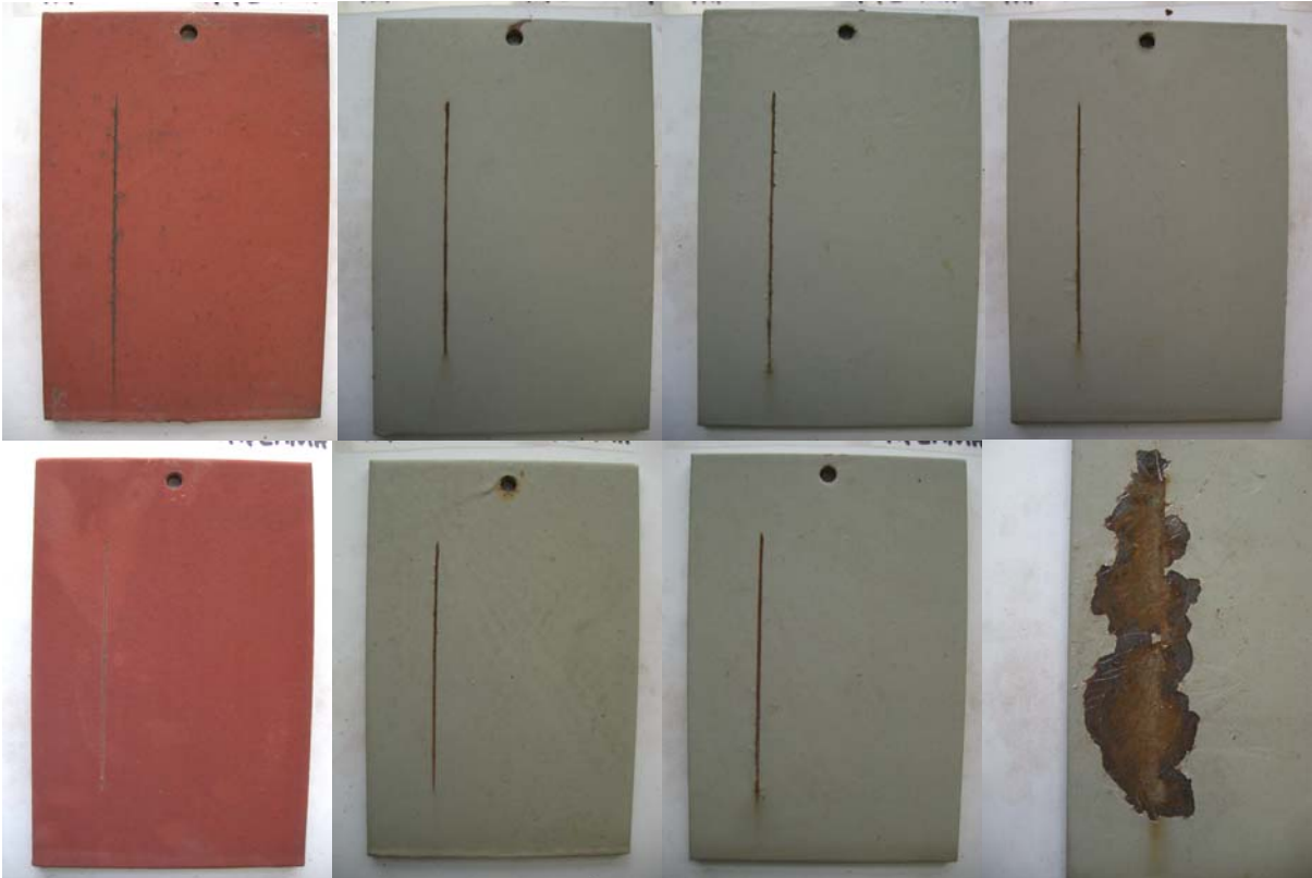
Şekil 4.10 Marshall Saha Testi Numuneleri. Taşlanmış. Sol üst köşeden sağ alt köşeye: Sistem 1, 2, 3, 4, 5, 6, 7 ve 8
