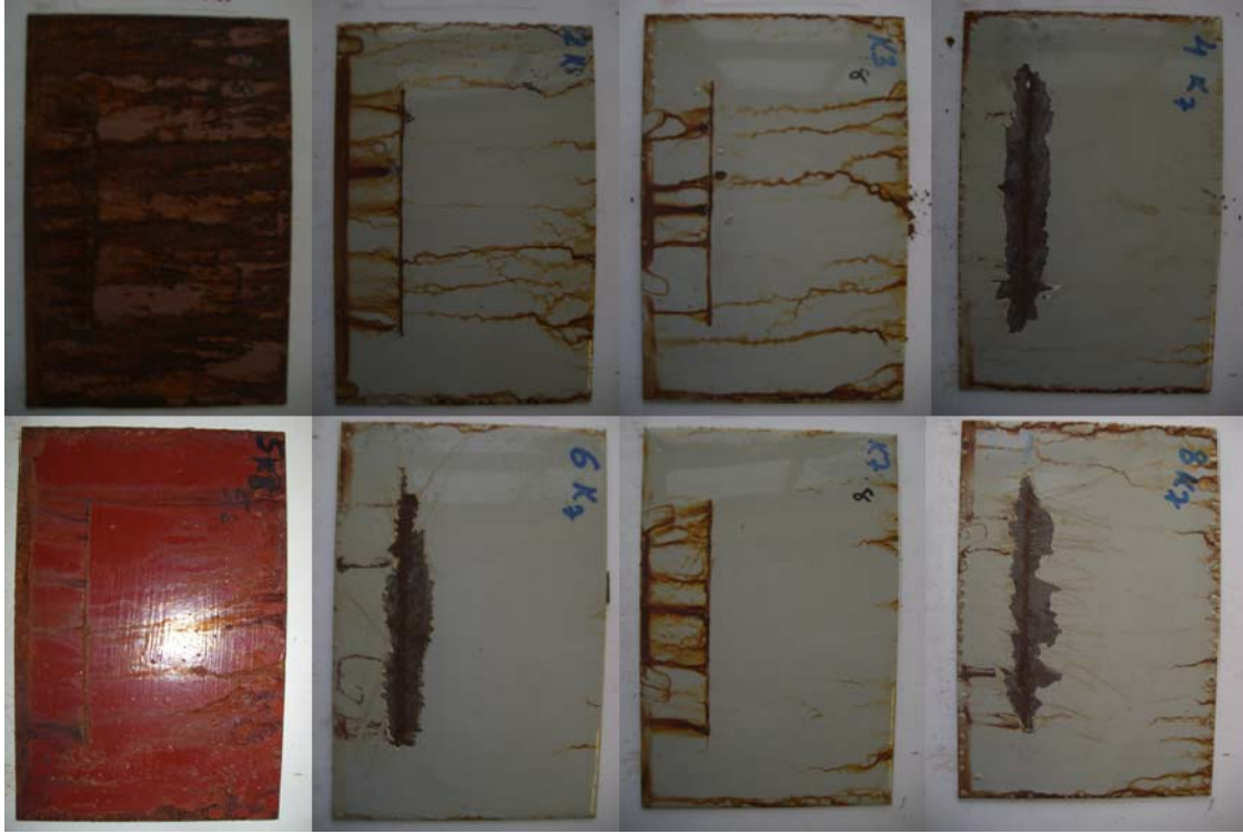
Şekil 4.19 960 Saatlik Tuz Piskürtme Testi için Numuneler. Kumlanmış. Sol üst köşeden sağ alt köşeye: Sistem 1, 2, 3, 4, 5, 6, 7 ve 8
