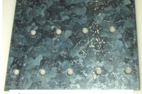
Şekil 2.15 Galvaniz kaplama (ASM Handbook, Vol 13, 1992)
