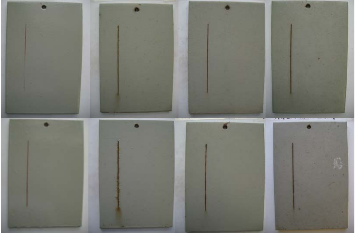
Şekil Ek 1.2 Sistem 2. Üst sıra Kumlanmış, alt sıra taşlanmış. Soldan Sağa: Şahit, Kınar, Marshall, Kalamış
