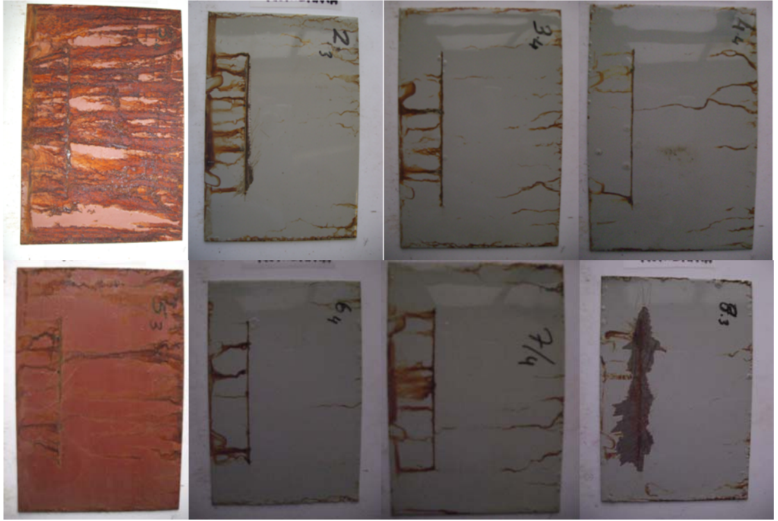
Şekil 4.17 720 Saatlik Tuz Püskürtme Testi için Numuneler. Kumlanmış. Sol üst köşeden sağ alt köşeye: Sistem 1, 2, 3, 4, 5, 6, 7 ve 8
