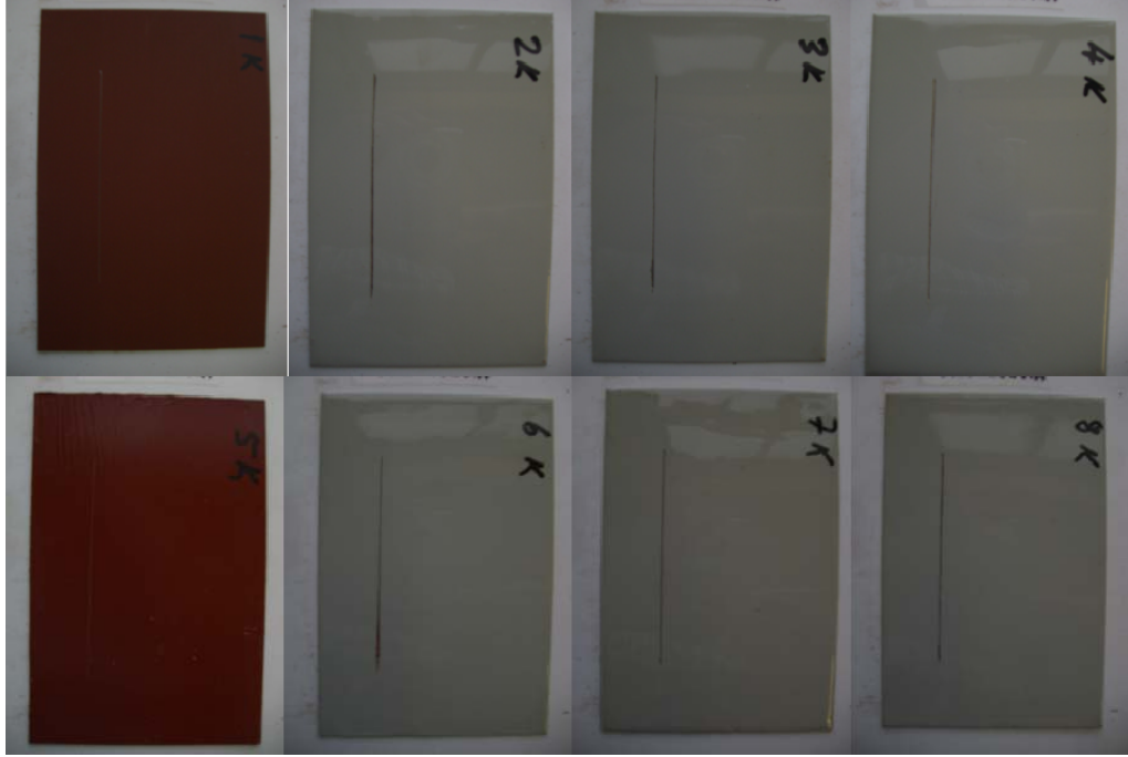
Şekil 4.13 Tuz Püskürtme Testi için Şahit Numuneler. Kumlanmış. Sol üst köşeden sağ alt köşeye: Sistem 1, 2, 3, 4, 5, 6, 7 ve 8
