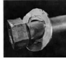
Şekil 2.1 , Çatlak korozyonu (ASM Handbook, Vol 13, 1992)
