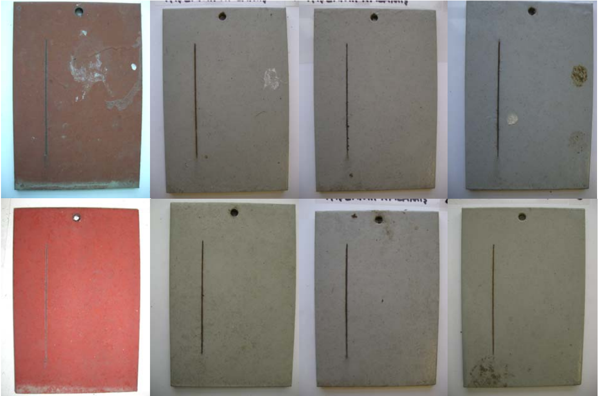
Şekil 4.12 Kalamış Saha Testi Numuneleri. Taşlanmış. Sol üst köşeden sağ alt köşeye: Sistem 1, 2, 3, 4, 5, 6, 7 ve 8
