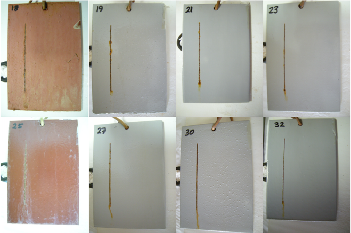
Şekil 4.26 SO 2 Testi 16. Gün. Taşlanmış. Sol üst köşeden sağ alt köşeye: Sistem 1, 2, 3, 4, 5, 6, 7 ve 8
