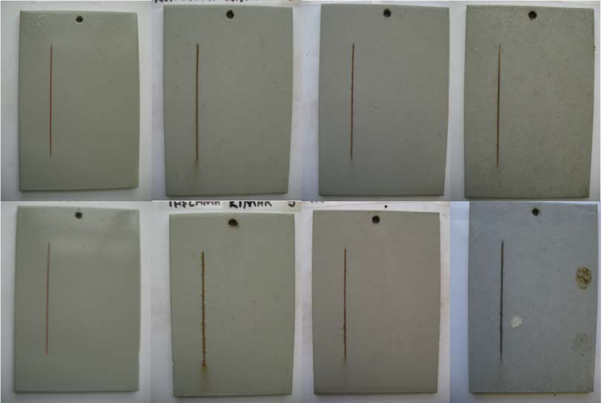
Şekil Ek 1.4 Sistem 4. Üst sıra Kumlanmış, alt sıra taşlanmış. Soldan Sağa: Şahit, Kına, Marshall, Kalamış
