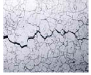
Şekil 2.5. Taneler arası korozyon (Özbaş, 2005)
