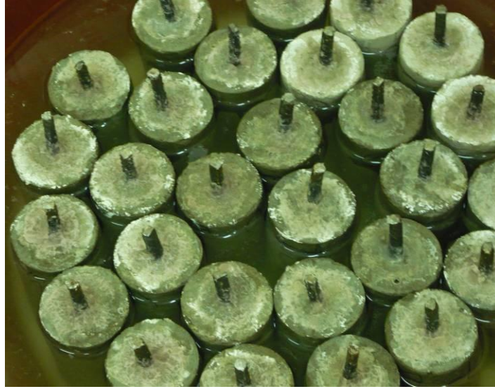
Şekil 5.2 Lolipop Silindirik Numunelerin NaCl Çözeltisindeki Görünüşü
