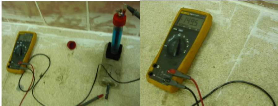
Şekil 5.3 Yarı Hücre Potansiyel Ölçümü Deney Düzeneği
