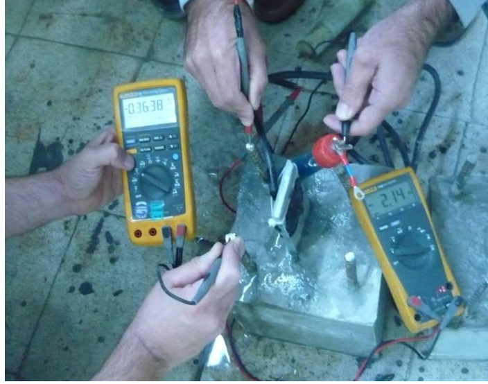
Şekil 5.14 Galvanik Anotlu Katodik Koruma Deney Düzenneği
