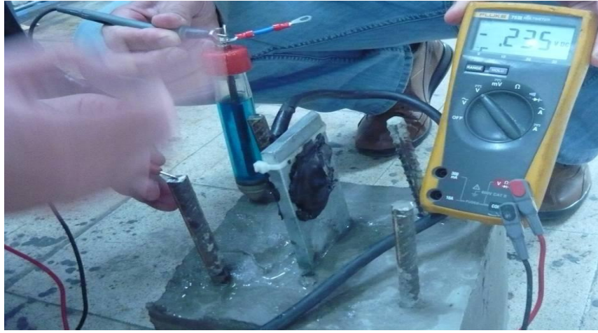
Şekil 5.68 Galvanik Anotlu Katodik Koruma Uygulanmadan Önce Betonarme Numunedeki Çelik Donatıların Yarı Hücre Potansiyel Ölçümü
