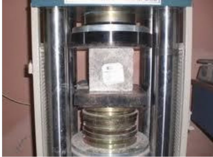
Şekil 5.11 Beton pres makinesi
