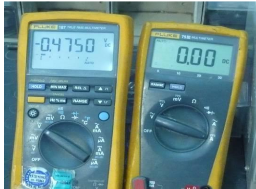
Şekil 5.66 Dış Akım Kaynaklı Katodik Koruma Uygulanmadan Önce Betonarme Numunedeki Çelik Donatıların Yarı Hücre Potansiyel Ölçümü
