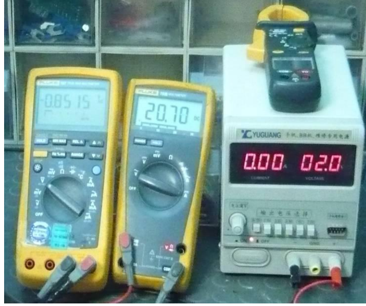
Şekil 5.67 Dış Akım Kaynaklı Katodik Koruma Uygulanırken Betonarme Numunedeki Çelik Donatıların Yarı Hücre Potansiyel Ölçümü
