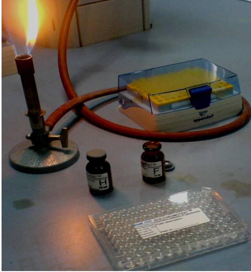
Şekil 4.12 Kromojenik substrat hazırlama ve mikro-kuyucuklara dağıtım
