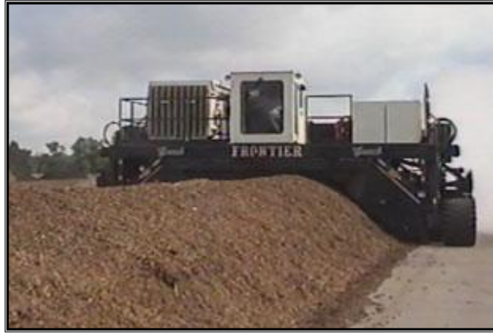
Şekil 4.8 Aktarmalı kompostlaştırma yığını ve karıştırıcı resmi.
