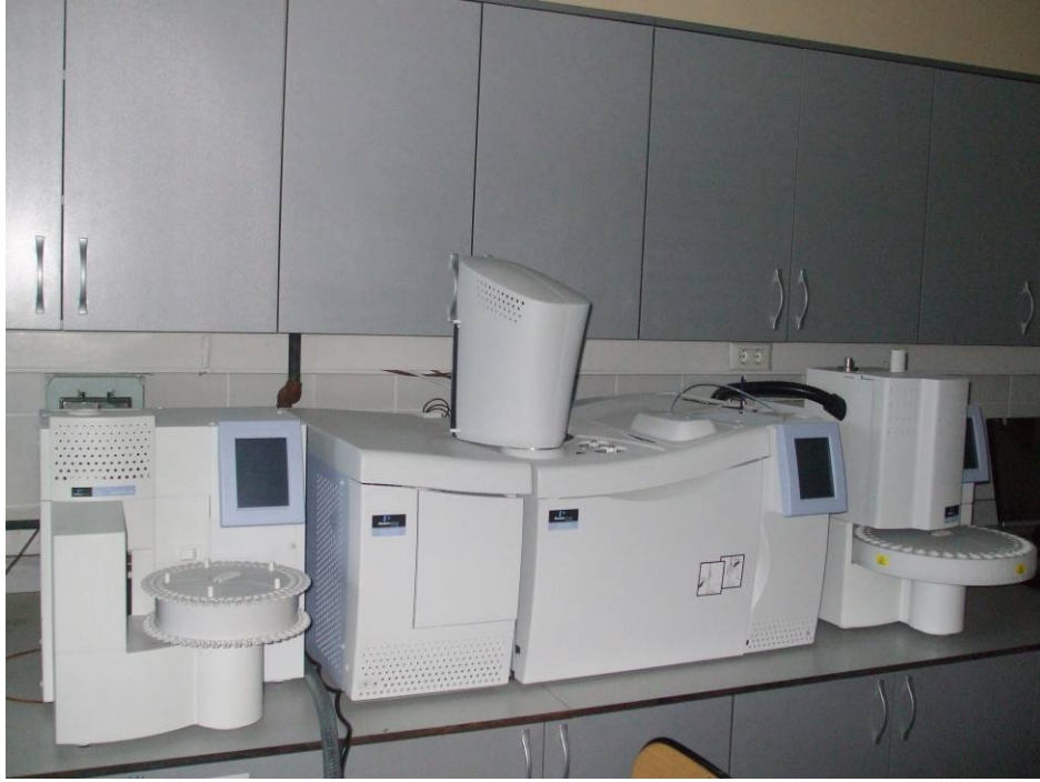
Şekil 2.8 GC-MS sisteminin görünümü (Soldan sağa: Termal desorpsiyon, Kütle spektroskopisi, Gaz kromatografi ve Headspace cihazları)
