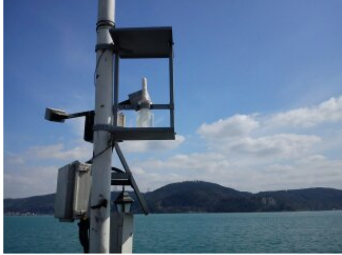
Şekil 2.3 İstanbul Sarıyer İDO iskelesine yerleştirilmiş Islak Fitil düzeneği
