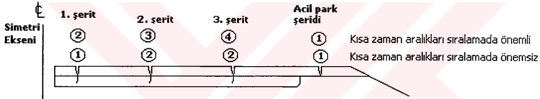
Şekil 4.11a. Analiz sonucu beklenen çatlak gelişim sırası
