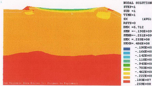
Şekil Ek3.11 Modifiye Proktor' un optimumunun %5 ıslak tarafında sıkıştırılan dolgunun Yükleme 1 (az ıslanma) durumunda üstyapıda gelişen çekme gerilmeleri ve bölgeleri
