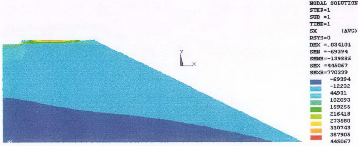
Şekil 4.8.a Dolgu ve üstyapı da kendi ağırlıkları sonucu oluşan SX yatay gerilme izobarları
