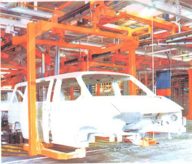
Şekil 1.10 Otomotiv sektöründe elektrikli asma konveyör hattı ( http://www.schierholz.com )
