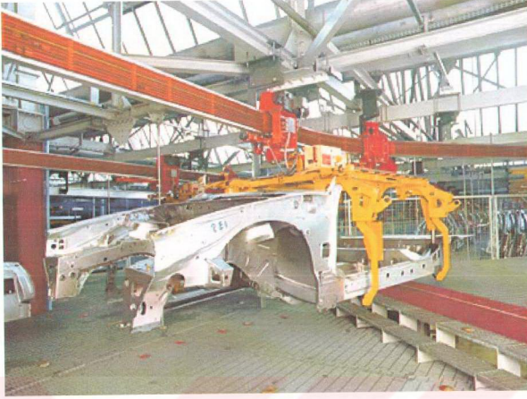
Şekil 1.9 Otomotiv sektöründe elektrikli asma konveyör hattı ( http://www.schierholz.com )
