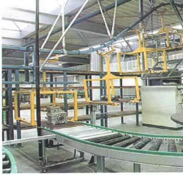
Şekil 1.8 Zincirli konveyör ile rulolu konveyör arasında malzeme transferi ( http://www.schierholz.com )
