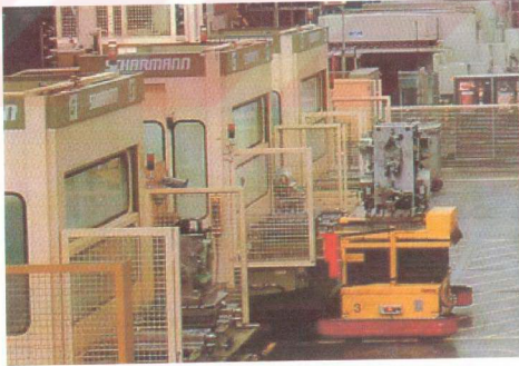
Şekil 1.37 Esnek imalat hücresinden malzeme transferi yapan AGV (Digitron AG.)
