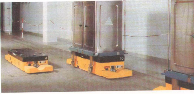
Şekil 1.35 Birim yük taşıyan AGV'ler (Digitron AG.)
