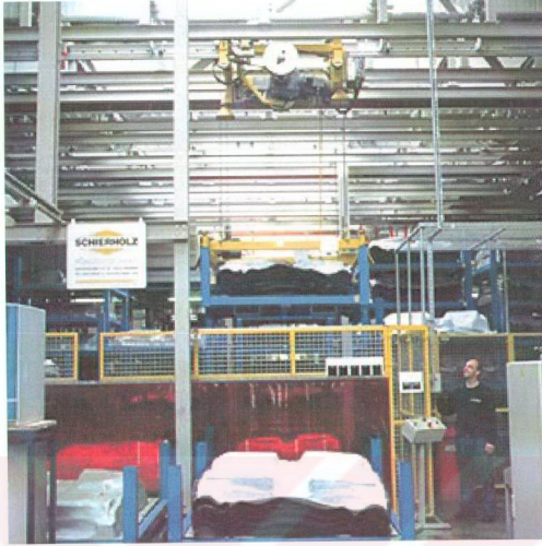
Şekil 1.11 Tekstil sektöründe elektrikli asma konveyör hattının liftli uygulaması ( http://www.schierholz.com )
