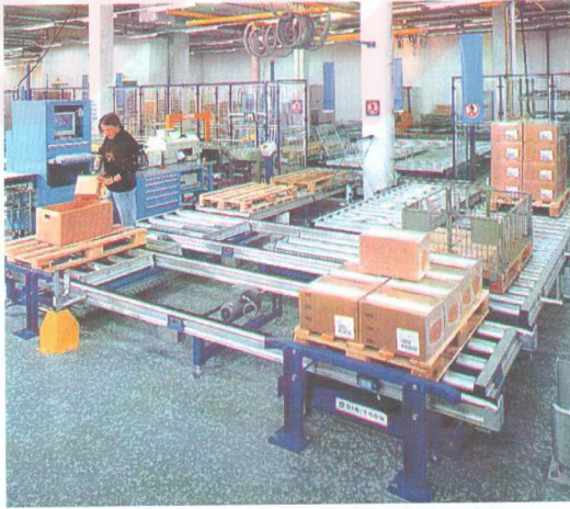
Şekil 1.4 Rulolu konveyörde barkod işleme (Digitron AG.)
