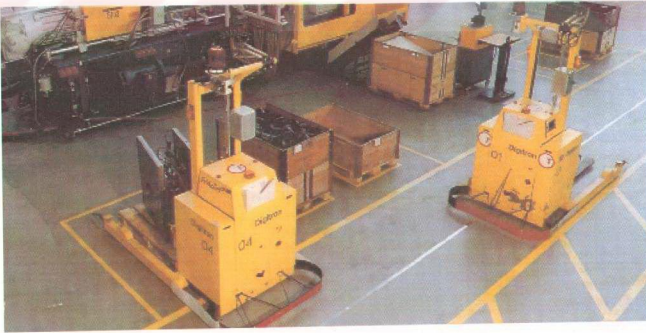
Şekil 1.34 Çatalılı AGV'ler (Digitron AG. )
