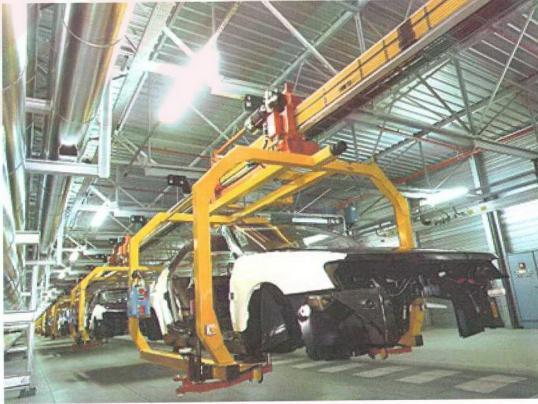
Şekil 1.12 Elektrikli asma konveyör hattının otomotiv montaj hattında kullanımı ( http://www.schierholz.com )
