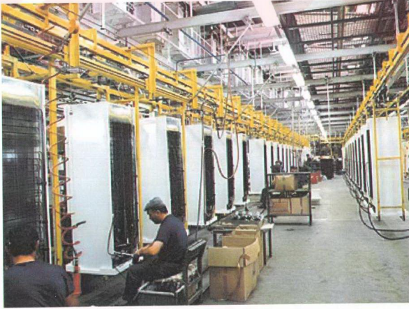
Şekil 1.15 Power and free asma konveyör hattı Arçelik Eskişehir ( http://www.swisslog.com )
