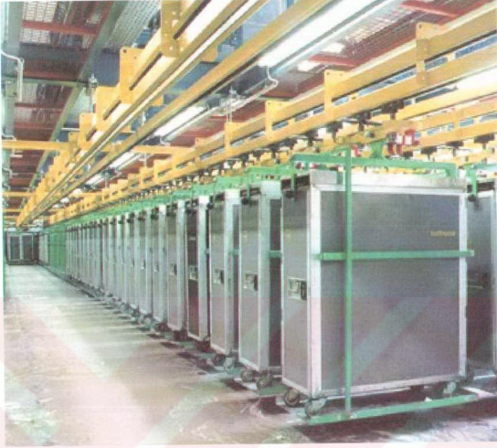
Şekil 1.16 Depolamada kullanılan Arabalı konveyör hattı ( http://www.schierholz.com )
