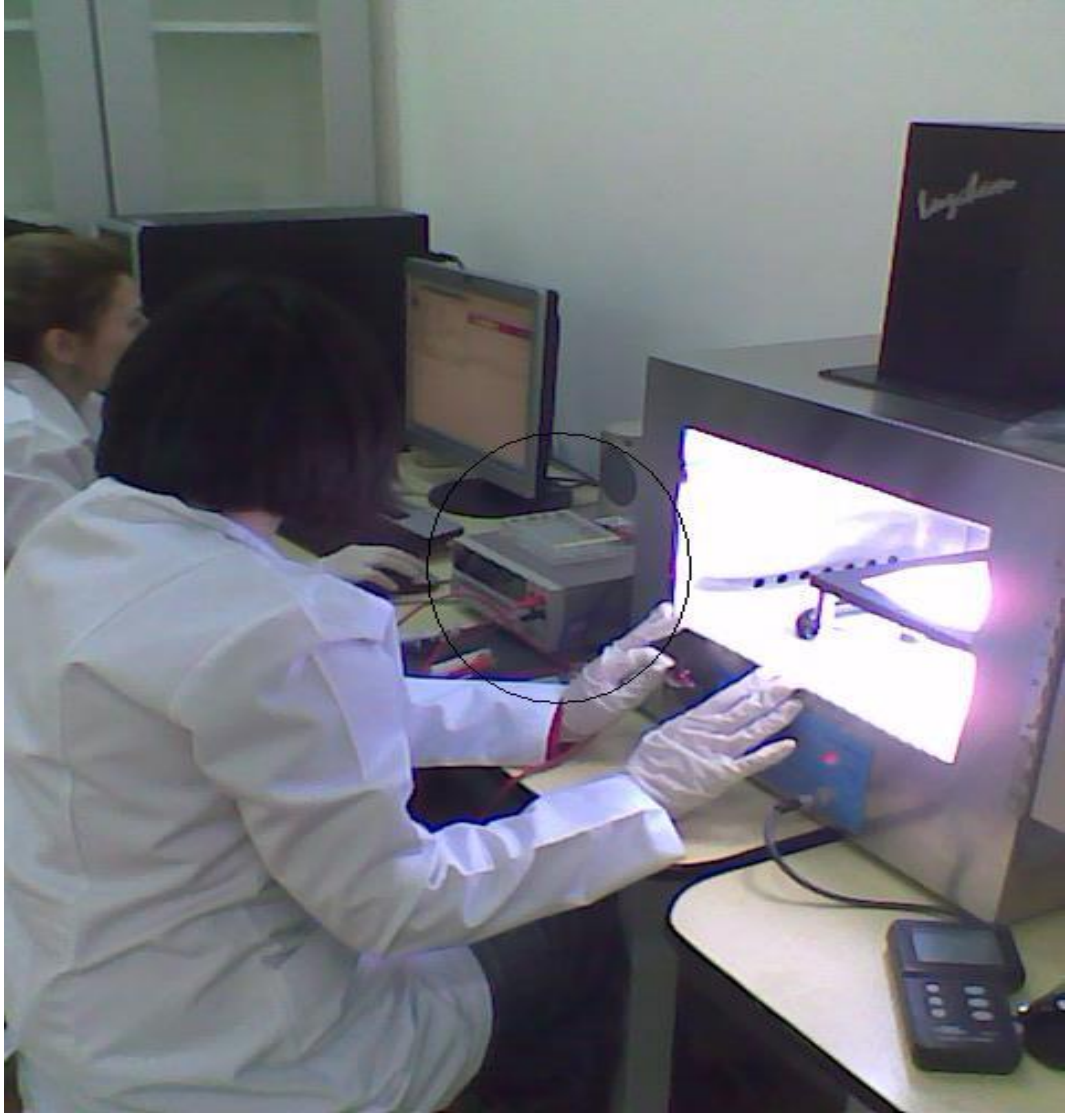
Şekil 7.6 Akım-gerilim karakterizasyonu için Keithley cihazı (yuvarlak içine alınmış olan cihaz). En sağdaki parlak görünen solar simülatördür.
