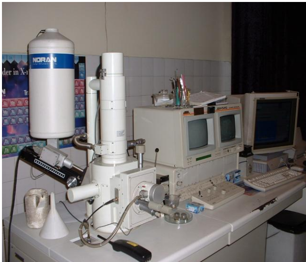
Şekil 3.6 Jeol 5410 model SEM cihazı ve şematik gösterimi
