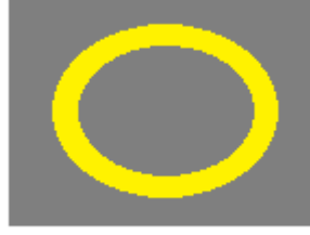
Şekil 3.2 Metal kontak kapaması için halka kontak maskesi
